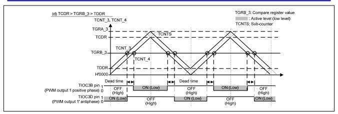
Figure 9 (d) Example of PWM Waveform Output
