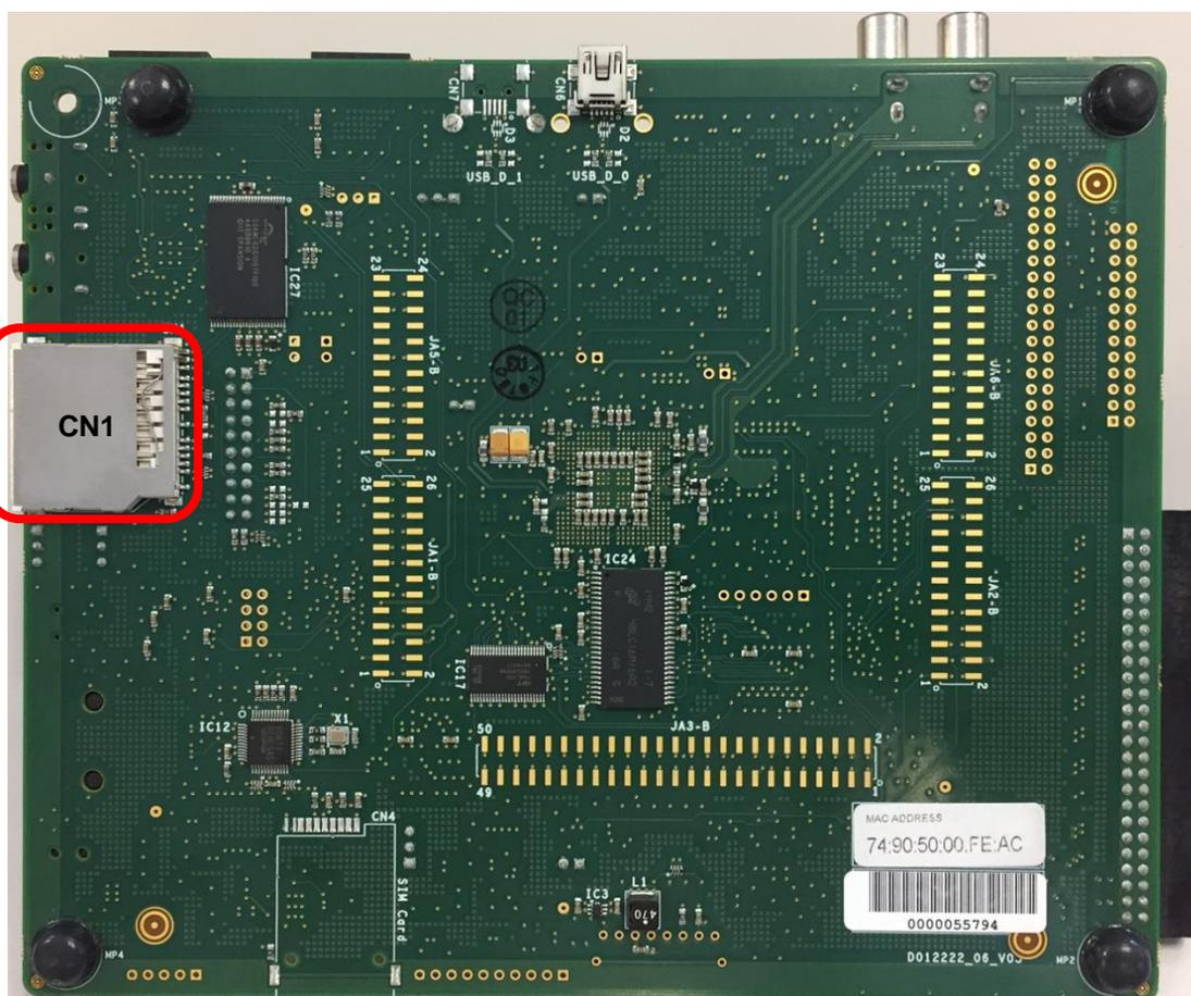
図 1 SD/MMC スロット位置（ボード S 面）
