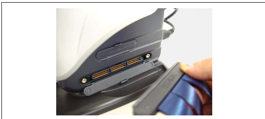
図 2.1 エバチップユニット使用時の E200F 側のトレースケーブル接続方法
