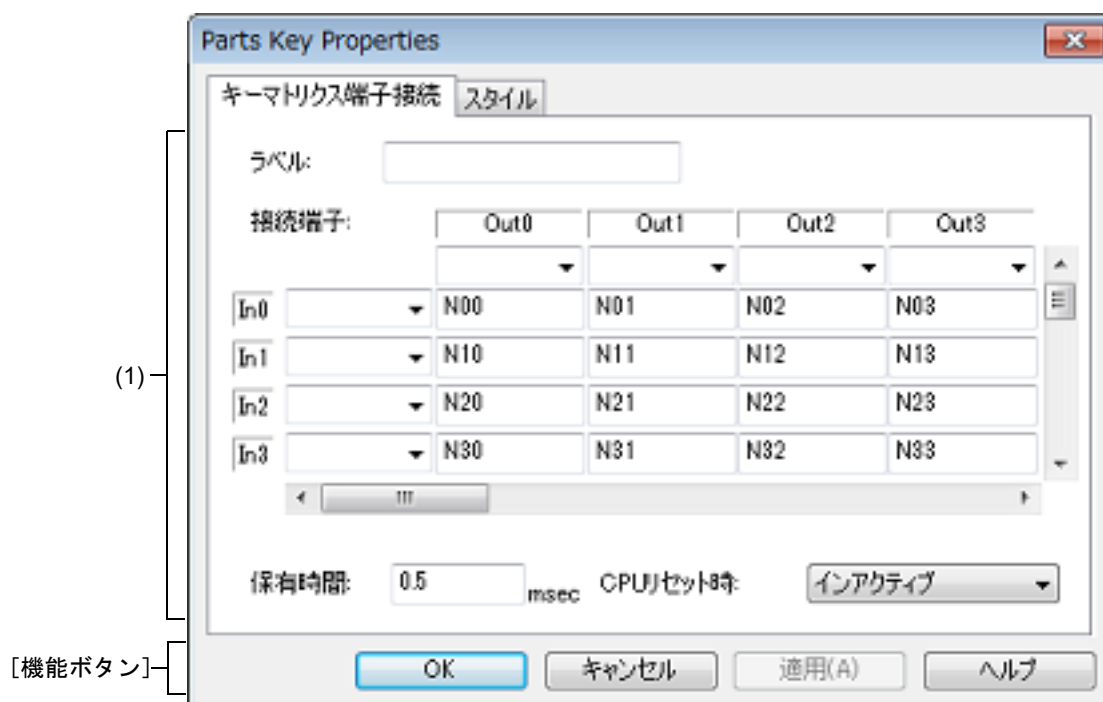
図 A.68 Parts Key Properties ダイアログ : [キーマトリクス端子接続] タブ
