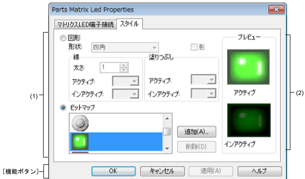
図 A.81 Parts Matrix Led Properties ダイアログ : [スタイル] タブ
