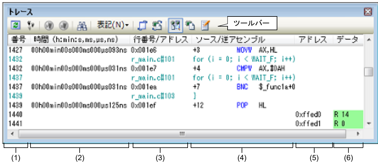
図 2.78 トレース・データの表示（トレースパネル）
