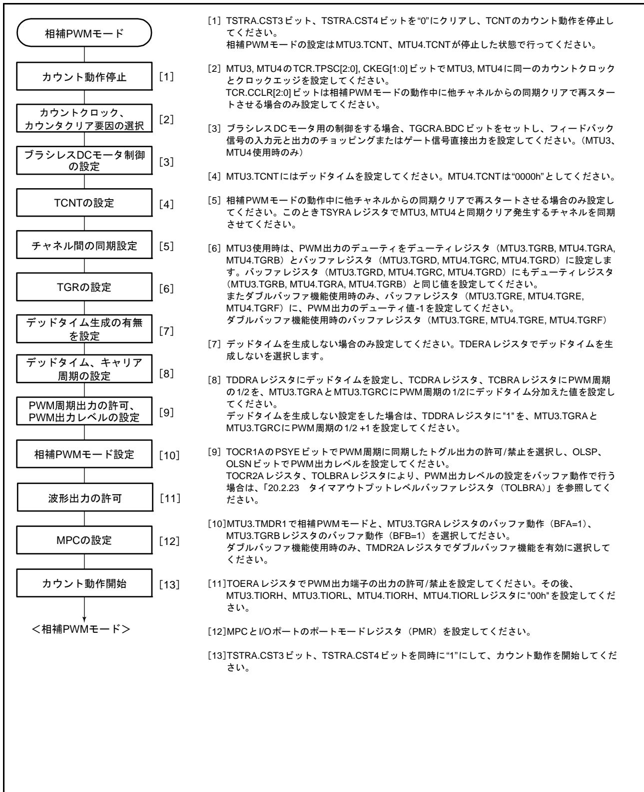
図 20.45 相補 PWM モードの設定手順例
