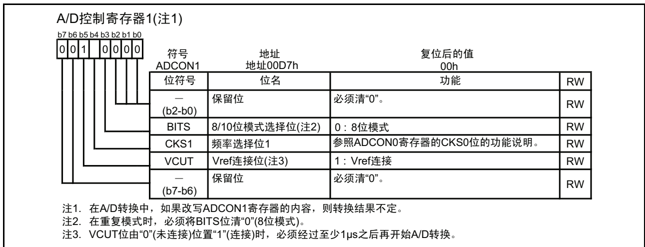
图 19.7 重复模式时的 ADCON1 寄存器
