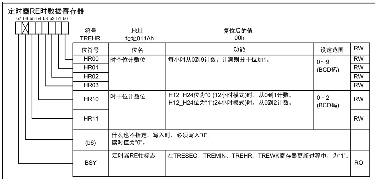
图 15.114 实时时钟模式时的 TREHR 寄存器
