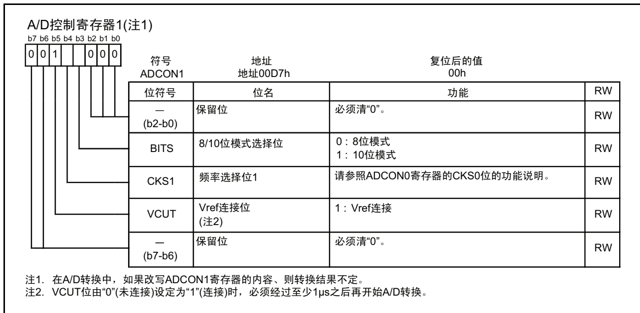
图 19.5 单次模式时的 ADCON1 寄存器
