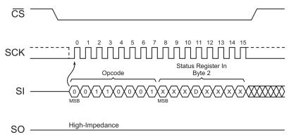
Figure 29. Write Status Register Byte 2
