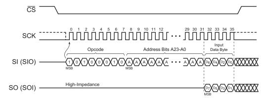
Figure 13. Dual-Input Byte Program
