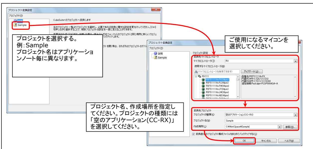
Figure 7-1 e<sup>2</sup> studio 用プロジェクトの CS+読み込み方法
