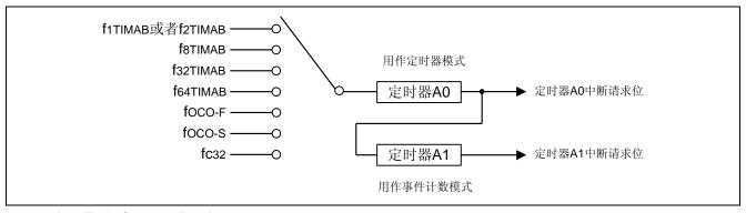
图 2. 长周期定时器的连接示意图
