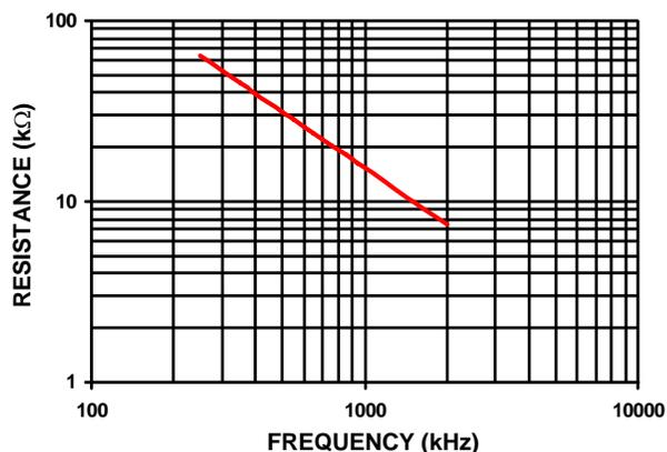
FIGURE 4. R<sub>FS</sub> RESISTANCE vs. FREQUENCY
