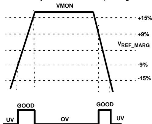
FIGURE 3. UNDERVOLTAGE-OVERVOLTAGE WINDOW
