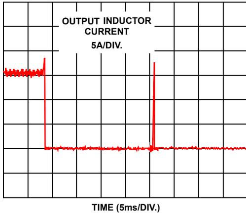
FIGURE 1. OVERCURRENT OPERATION
