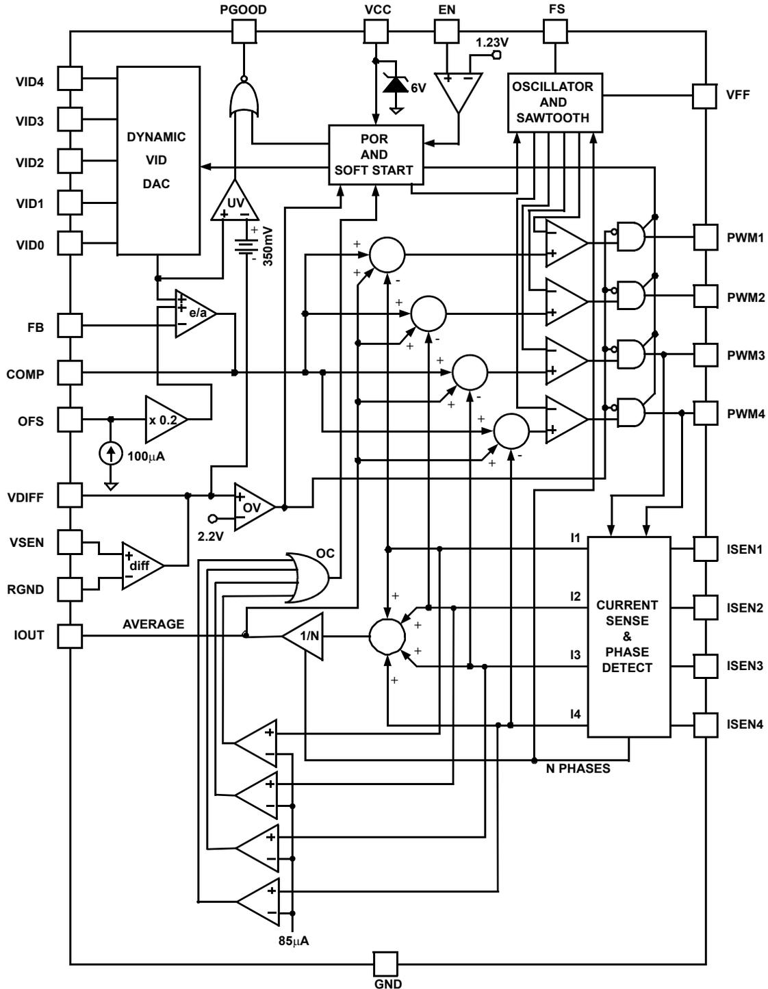
FIGURE 12. BLOCK DIAGRAM
