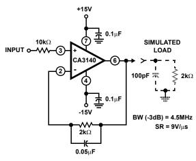
**FIGURE 28A. TEST CIRCUIT**
