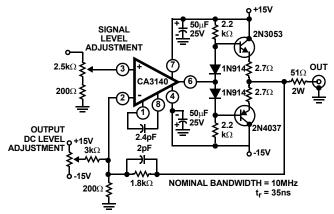
FIGURE 14. WIDEBAND OUTPUT AMPLIFIER
