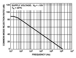
FIGURE 34. COMMON MODE REJECTION RATIO vs FREQUENCY
