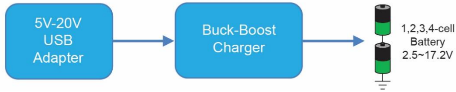
图 5. 升压-降压充电器方案
