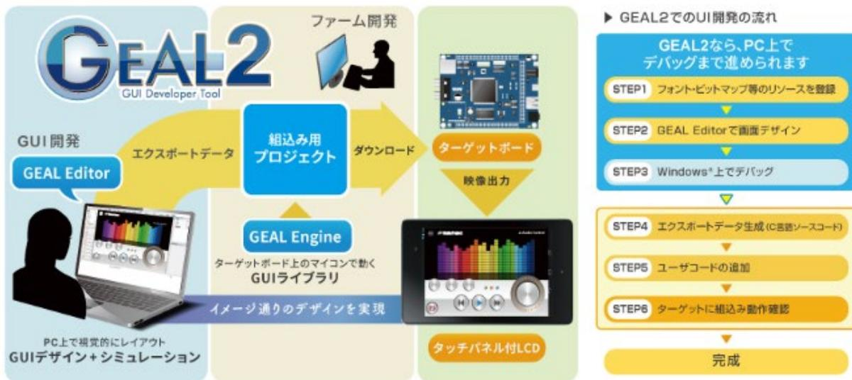
GEAL2 (ジール 2) は、Windows 上のデザインツールと、GUI コンポーネントで構成した組込み GUI 統合開発環境です。各種コンポーネントをデザインツールで視覚的にレイアウト、機能定義し、ユーザーアプリケーションと結合する事で、自由度の高い GUI アプリケーションを実現します。C 言語ベースによる「組み込み開発を意識した」構造になっており、既存のプログラム開発環境への導入が極めてスムーズに行えます。また、組込み製品向けに必須の「高速、コンパクト」を実現した上で、ユーザーのオリジナリティを引き出すカスタマイズ機能、またアプリケーションの再利用性を考慮したプログラマフレンドリーなツールとして、開発効率の向上に大きく寄与します。
