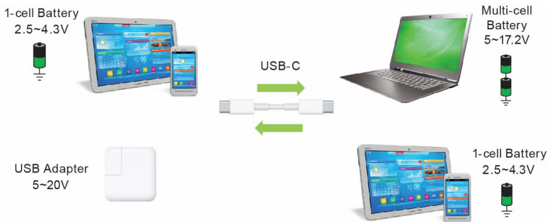
Bild 2: Neue Stromversorgungsarchitektur auf Basis des USB-Typ-C-Steckers
