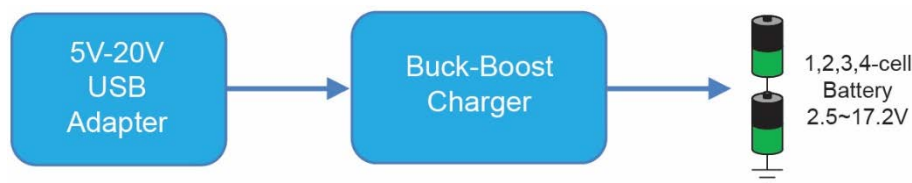
Bild 5: Buck-Boost-Ansatz für das Laden von Akkus
