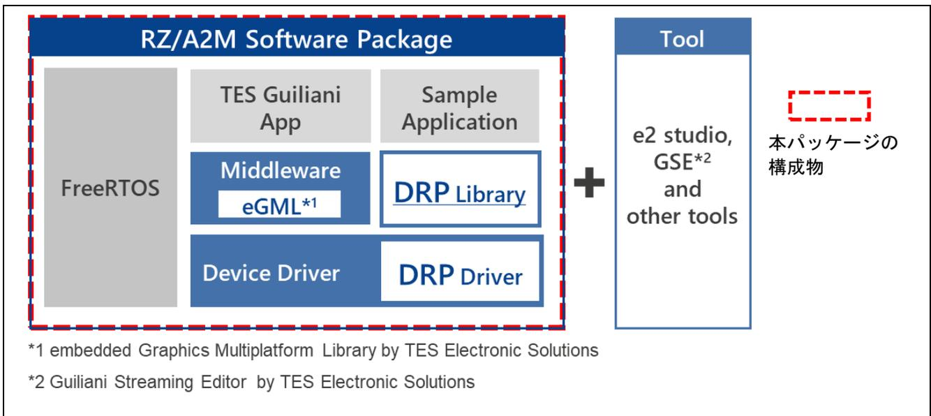
図 1 RZ/A2M Software Package 構成イメージ
