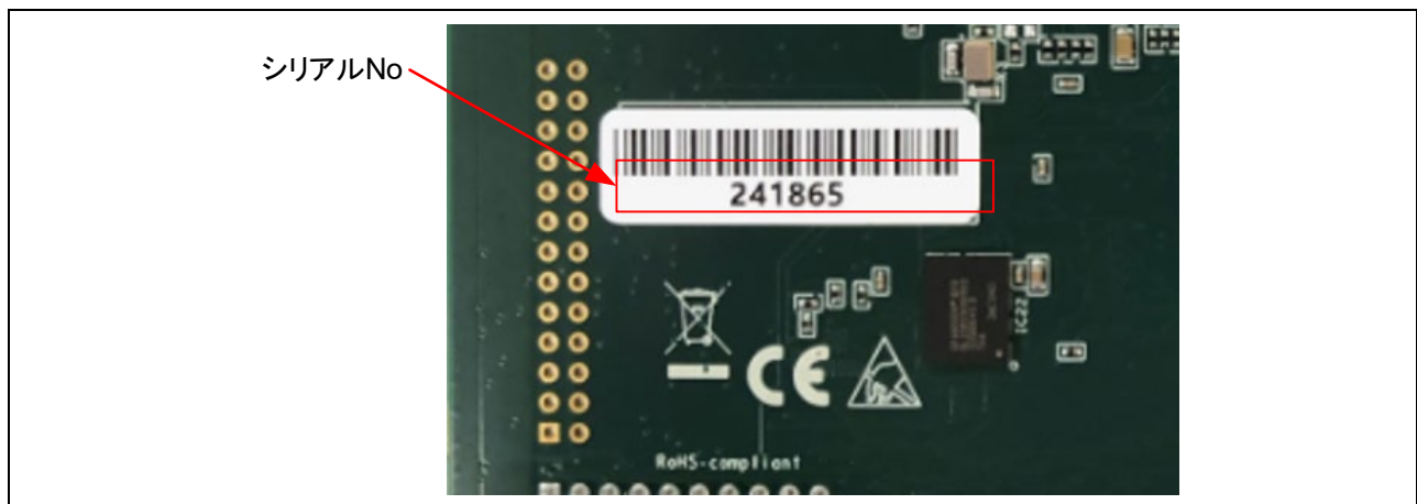
図 1 シリアル No 貼付位置(CPU ボード半田面)
