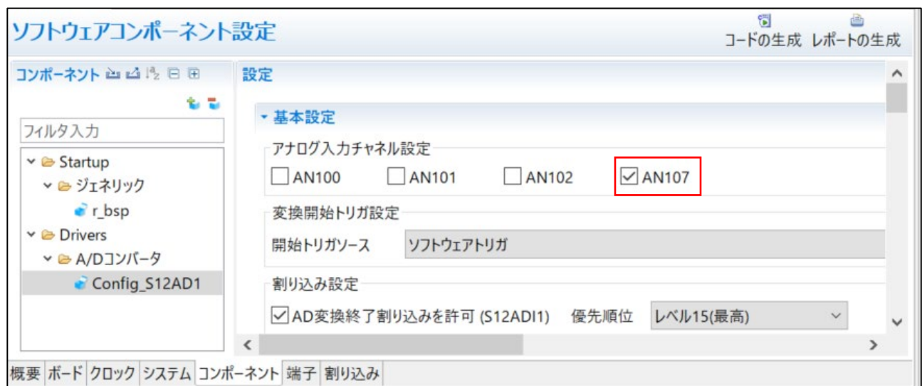
図 3-1 連続スキャンモード S12AD コンポーネントで AN107 の設定画面
