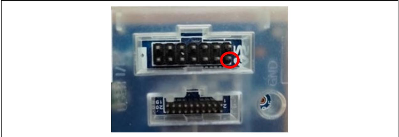
図2.6 14pinコネクタGNDピン位置
