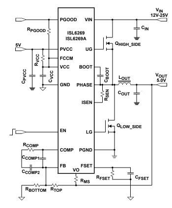
FIGURE 5. SCHEMATIC OF 5V  $V_{\mbox{\scriptsize OUT}}$  APPLICATION
