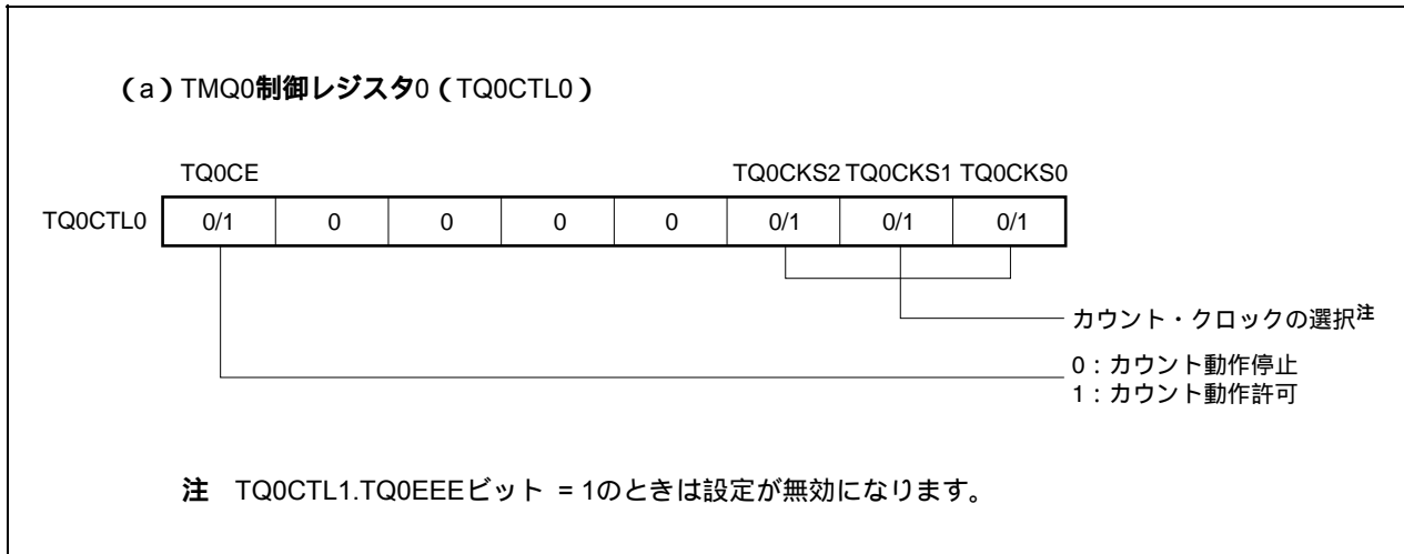
図7 - 24 外部トリガ・パルス出力モード動作時のレジスタ設定内容（1/3）
