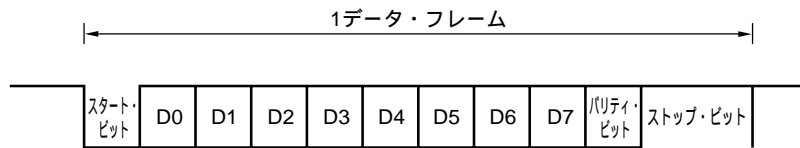
図11-7 アシンクロナス・シリアル・インタフェースの送受信データのフォーマット
