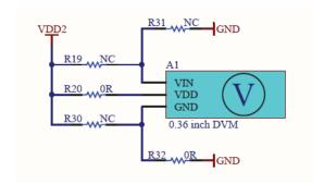
Figure 16: Digital Voltmeter
