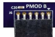
PMOD B上の信号は、メインMCUピンヘッダJ1およびJ2で共有されます。共用された信号が、同時に使用されないように注意してください。
