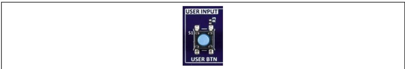
図 16 ターゲットボード上のユーザースイッチ (S1)
