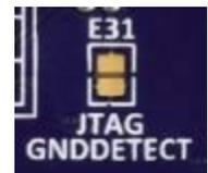
J-Link® OB インタフェースは JTAG インタフェースと多重化されており、プログラミングインタフェースと総称されます。J-Link® OB インタフェースと JTAG インタフェースは競合しませんが、はんだジャンパーを「5.4.2 デバッグ USB」で説明されている方法で変更することで J-Link® OB 信号をプログラミングインタフェースから分離させることが可能です。
