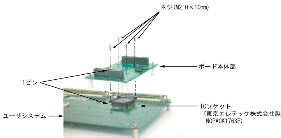
図2 ユーザシステムへの接続
