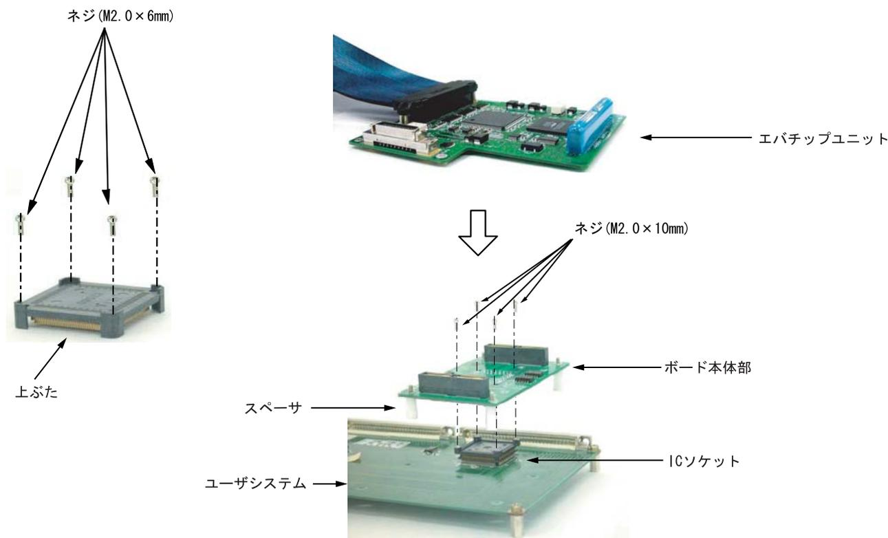
図 1 SH7286 PLQP0176LB-A 用ユーザシステムインタフェースボード
