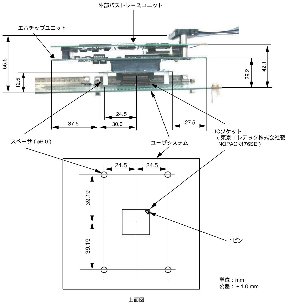
図7 ユーザシステムインターフェースボード接続時のユーザシステムとの寸法
