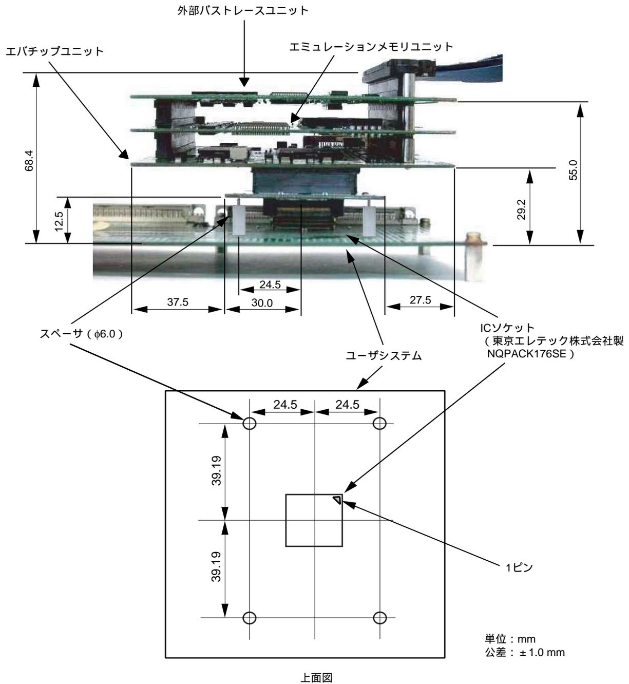
図6 ユーザシステムインタフェースボード接続時のユーザシステムとの寸法
