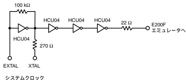
図 1 0 クロック発振回路
