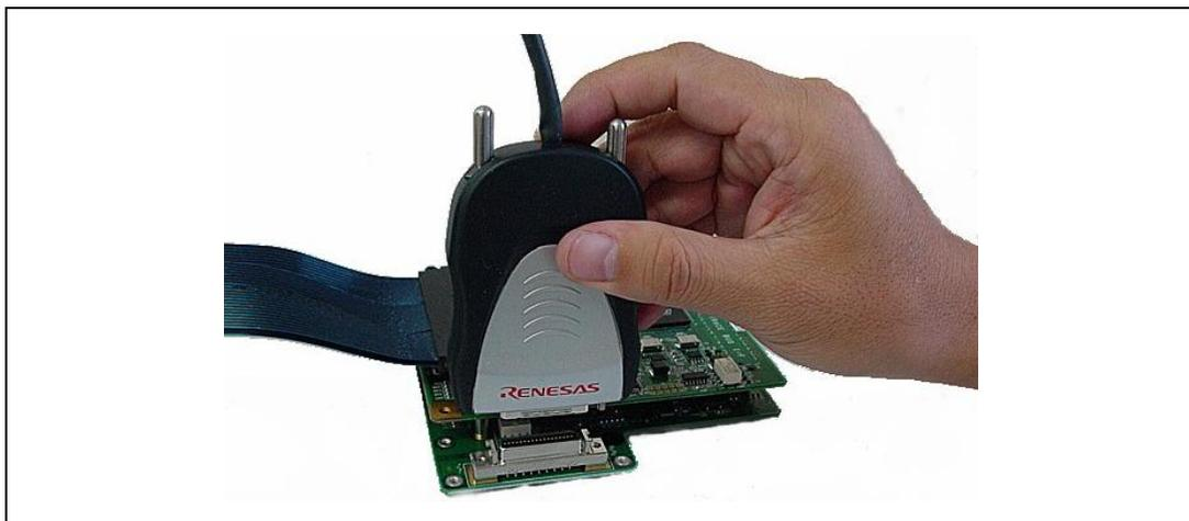
図 2.5 先端プローブとエバチップユニットの接続方法
