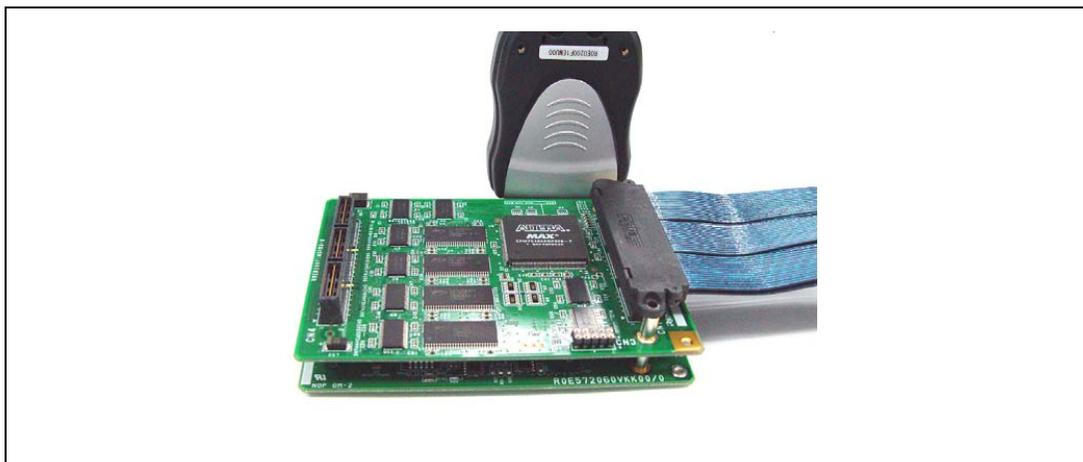
図 2.7 エミュレーションメモリユニット、エパチップユニット、およびトレースケーブルの接続方法
