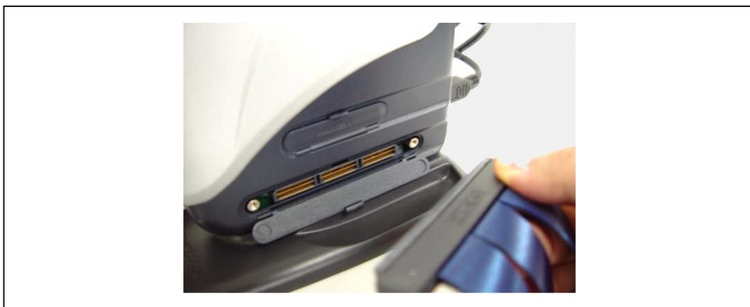
図 2.1 エバチップユニット使用時の E200F 側のトレースケーブル接続方法
