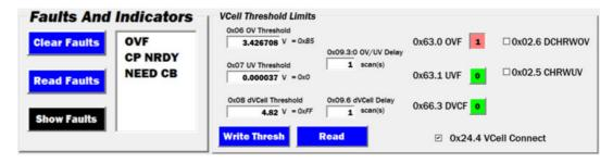
Figure 29. OV Fault
