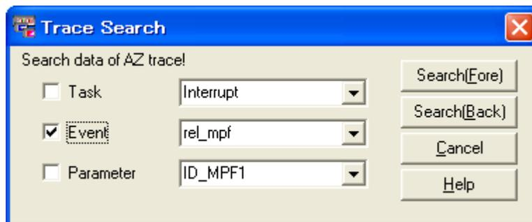
図 A—21 指定例 3 (ID\_MPF1 に対してサービス・コールを発行した箇所を検索)
