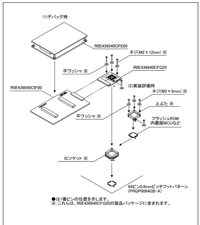
図2 R0E436640CFG20の使用方法
