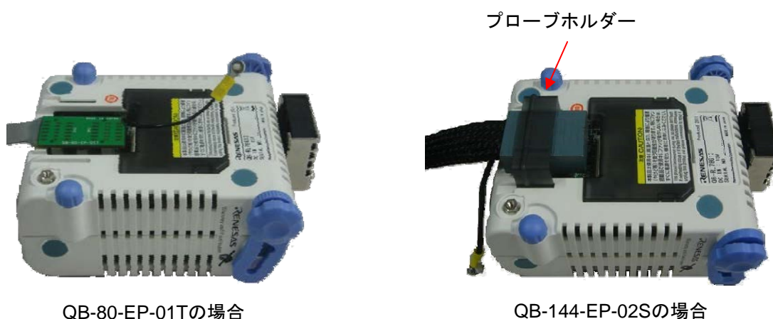
図2-7 エミュレーション・プローブの接続方法
