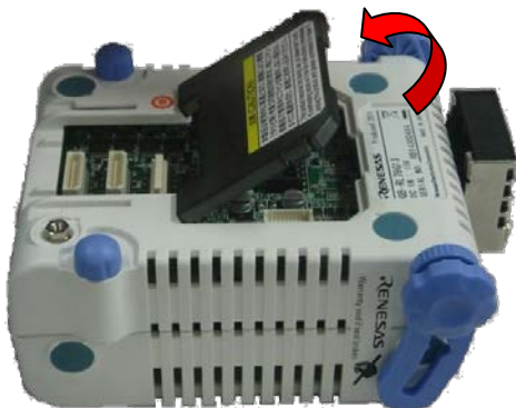
図2-1 アクリル板の取り外し方法
