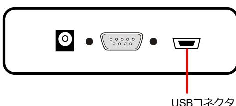
注：USB コネクタ（ミニ B タイプ） 型名：UX60SC-MB-5S8（ヒロセ電機株式会社製）
