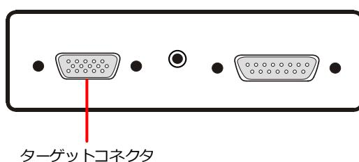
図10.8 ターゲットコネクタ (FP6 ターゲットコネクタ面)
