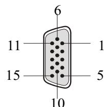
図10.11 ターゲットケーブル（14 ピンタイプ）D-sub 15 ピン（オス）のピン配置
