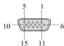
注：ターゲットコネクタ (D-sub 15 ピンコネクタ (メス)) 型名 : D02-M15SAG-20L9E (JAE 社製)
