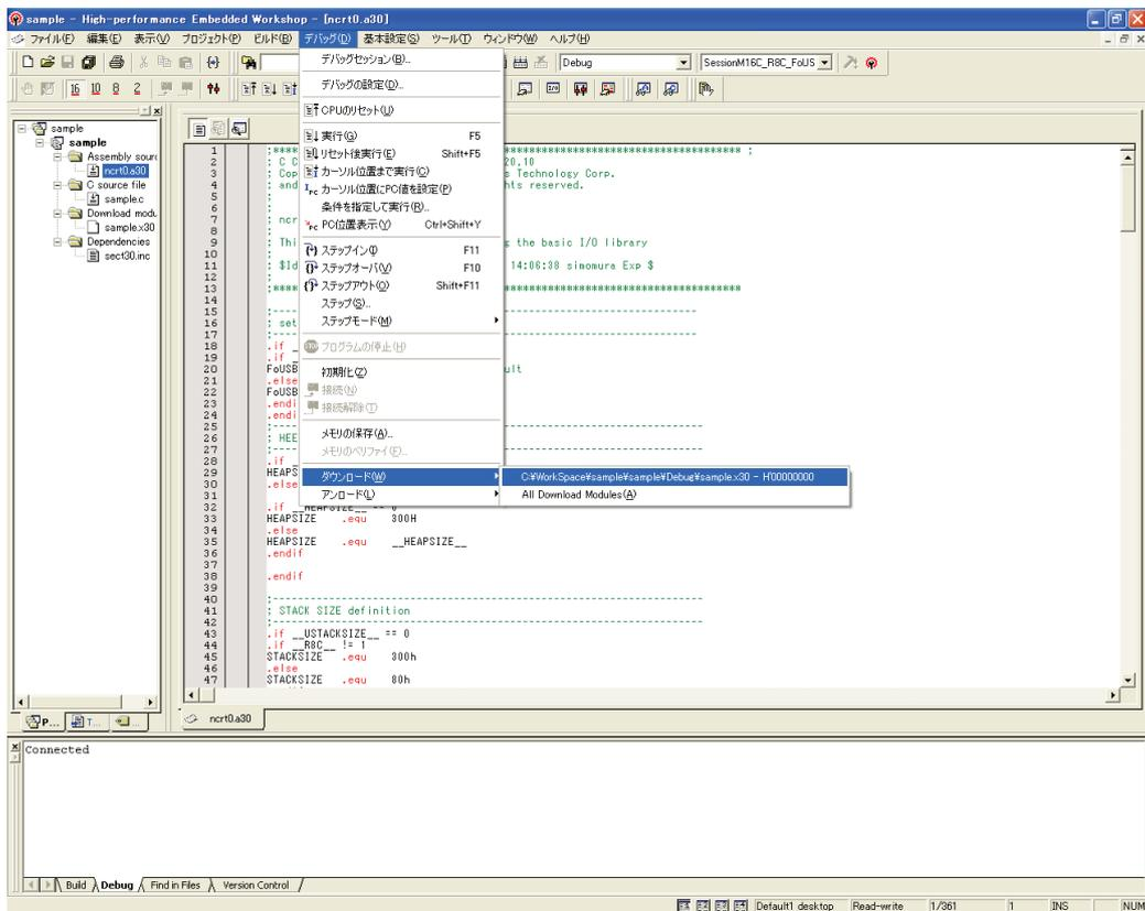
u) 「デバッグ」 - 「CPUのリセット」でユーザプログラムをリセットします。
