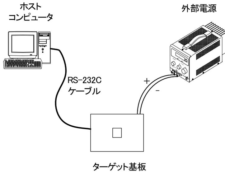
図 1 ユーザシステムとの接続例
