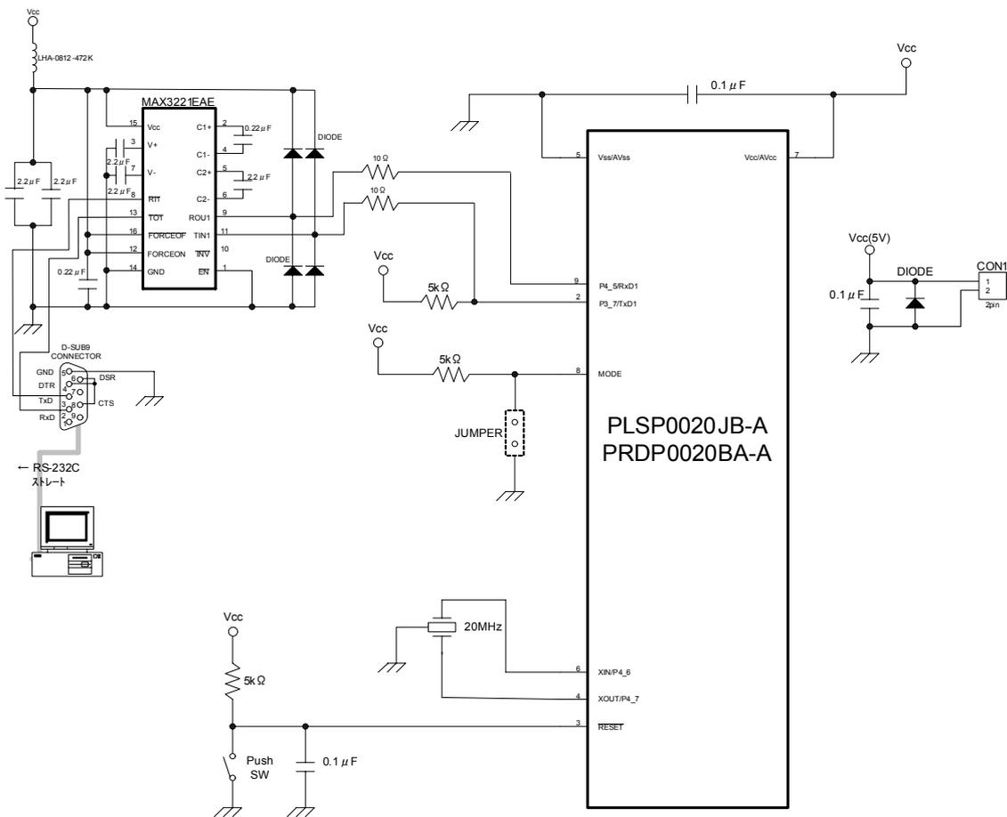
図 2 RS-232C ケーブルを使用した回路例
