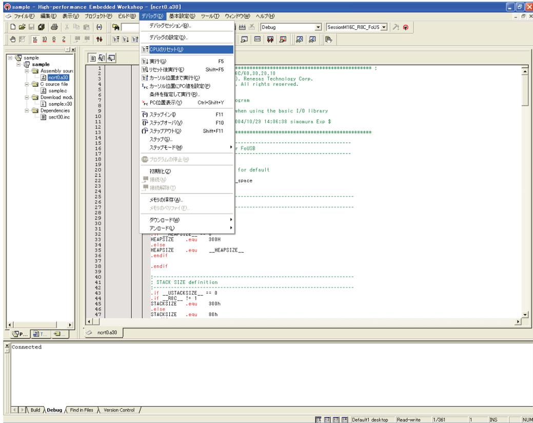
v) ユーザプログラムの先頭にカーソルが移動し、デバッグを開始できます。
