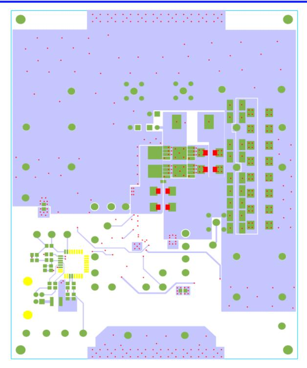
FIGURE 22. BOTTOM LAYER COPPER
