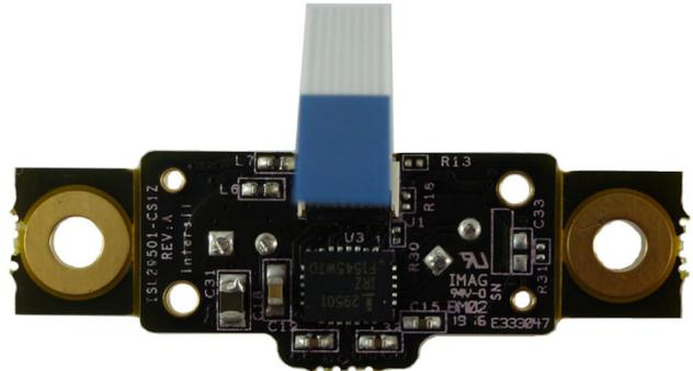
Figure 3. ISL29501-CS1Z Bottom.
