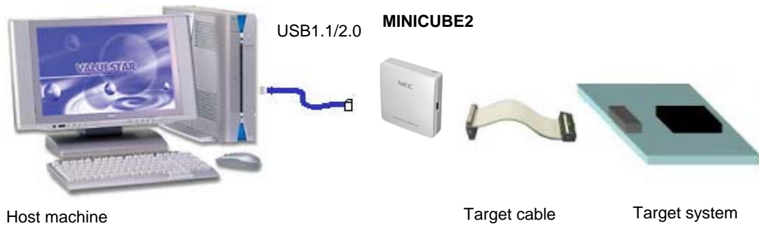
图 1-4: ID850QB 系统配置范例(MINICUBE2)
