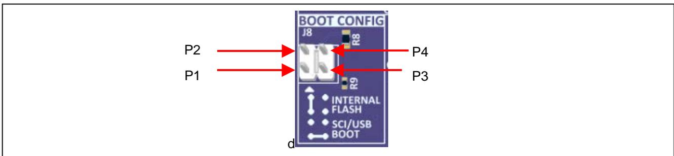
**Figure 29. Boot Config Jumper J8**
