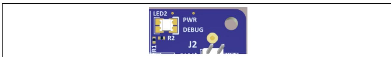
図 11 本評価キットボード上の LED2 (上面)
