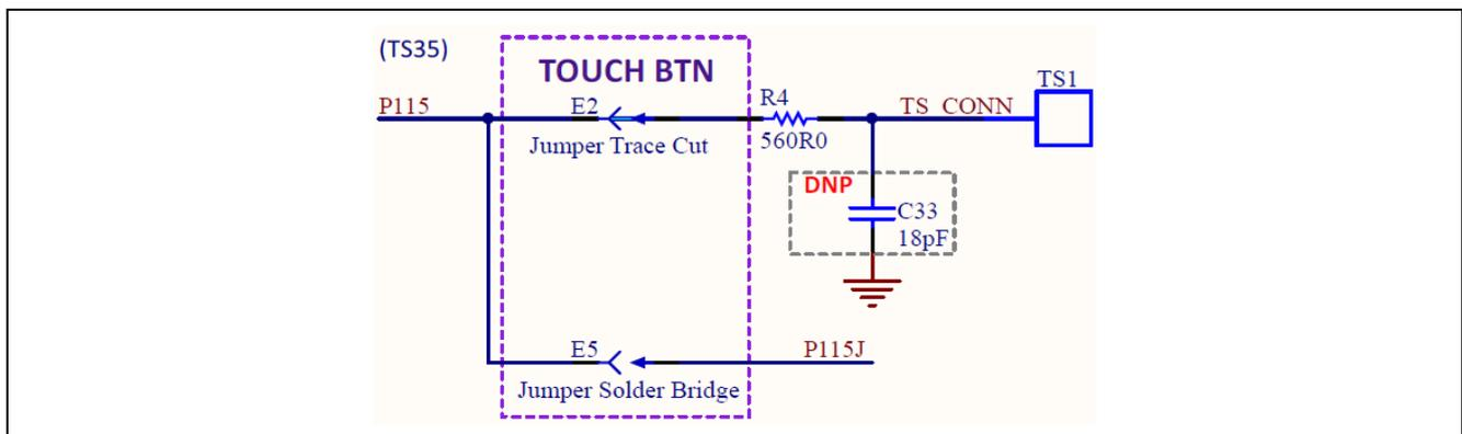
図 20 静電容量式タッチボタン回路
