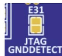
J-Link® OB インタフェースは JTAG インタフェースと多重化されており、プログラミングインタフェースと総称されます。J-Link® OB インタフェースと JTAG インタフェースは競合しませんが、はんだジャンパを「5.4.2 デバッグ USB」で説明されている方法で変更することで J-Link® OB 信号をプログラミングインタフェースから分離させることが可能です。
