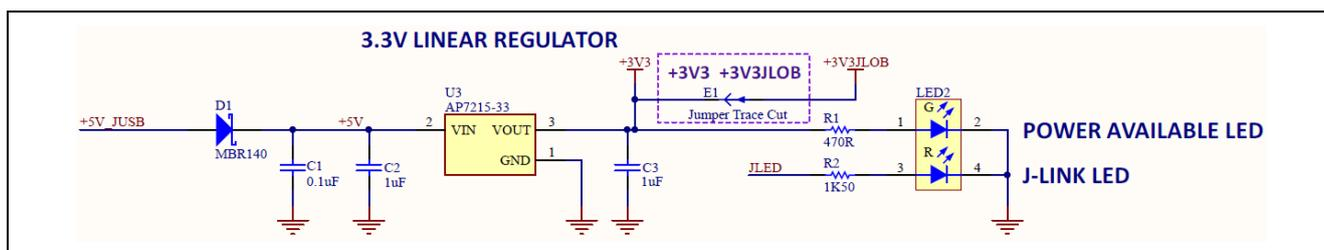
図 10 3.3 V 電源レギュレータ回路
