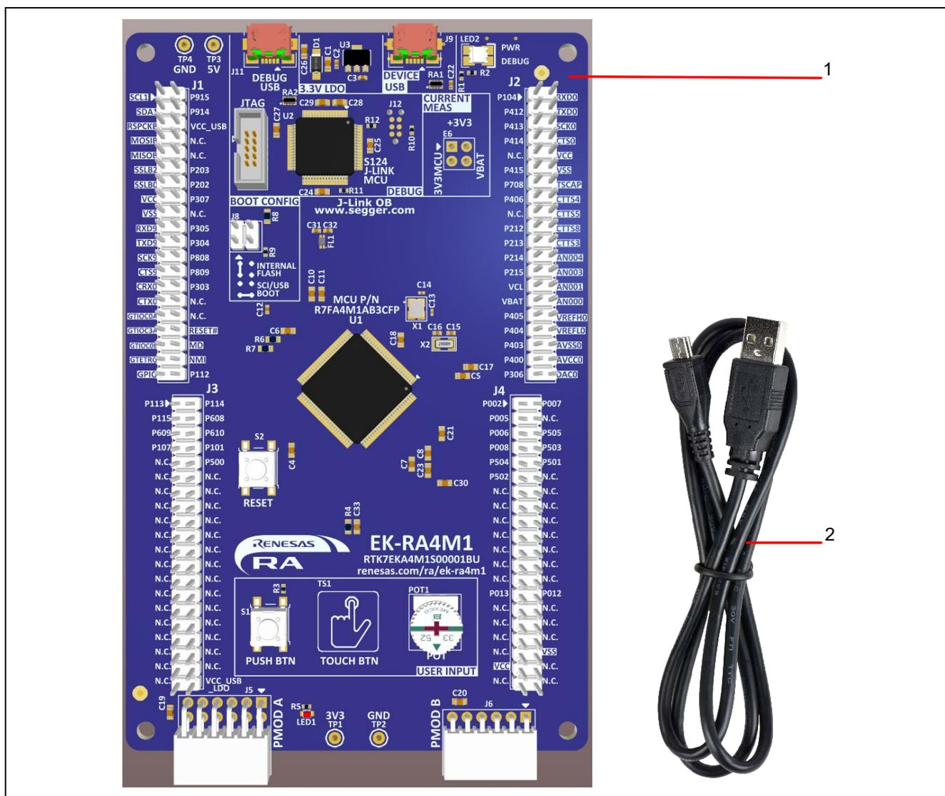
図3 EK-RA4M1 v1 評価キット構成
