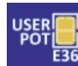
ユーザポテンショメータを取り付ける場合は、はんだジャンパ E36 をクローズして、ユーザポテンショメータを MCU に接続してください。
