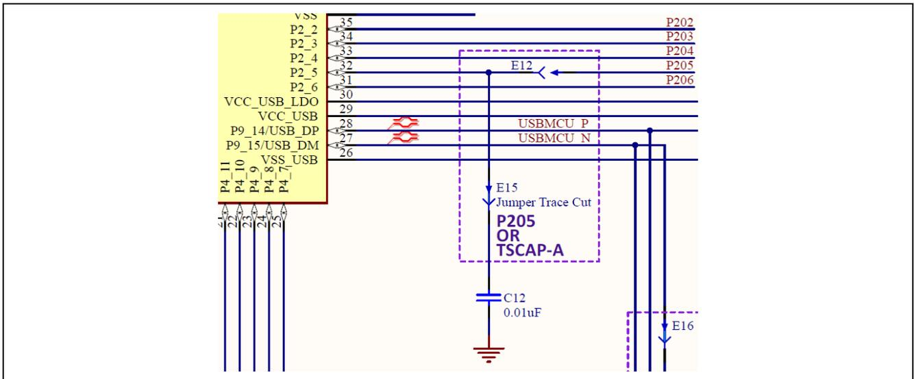
図 21 静電容量式タッチ TSCAP 回路
