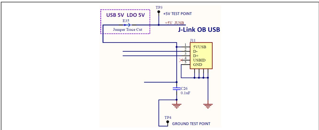
図 9 5 V 電源入力回路
