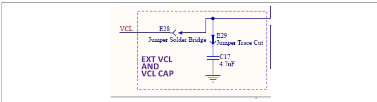
図 30 外部コンデンサと VCL 回路の接続
