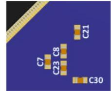
ポート P010/P011 のペアは、バイパスコンデンサ C21 が信号品質を損なう箇所の GPIO として割り当てることができます。P010/P011 を VREFH0/VREFL0 として割り当てるとき、コンデンサ C21 を設置することにより、リファレンス電圧ノイズを低減し、ADC 測定値と DAC 出力品質を向上させることができます。本ボードは、Samsung P/N CL10B104KB8NUNC、または同様のノイズバイパスコンデンサを搭載できるように設計されています。
