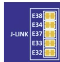
J-Link 未接続はんだジャンパ E32、E33、E34、E37、および E38 は、J-Link®信号を MCU プログラミングインタフェースに接続します。J-Link®信号を JTAG インタフェースから分離するには、はんだジャンパをオープンにしてください。J-Link®インタフェースを使用可能にするには、各はんだジャンパをクローズにしてください。
