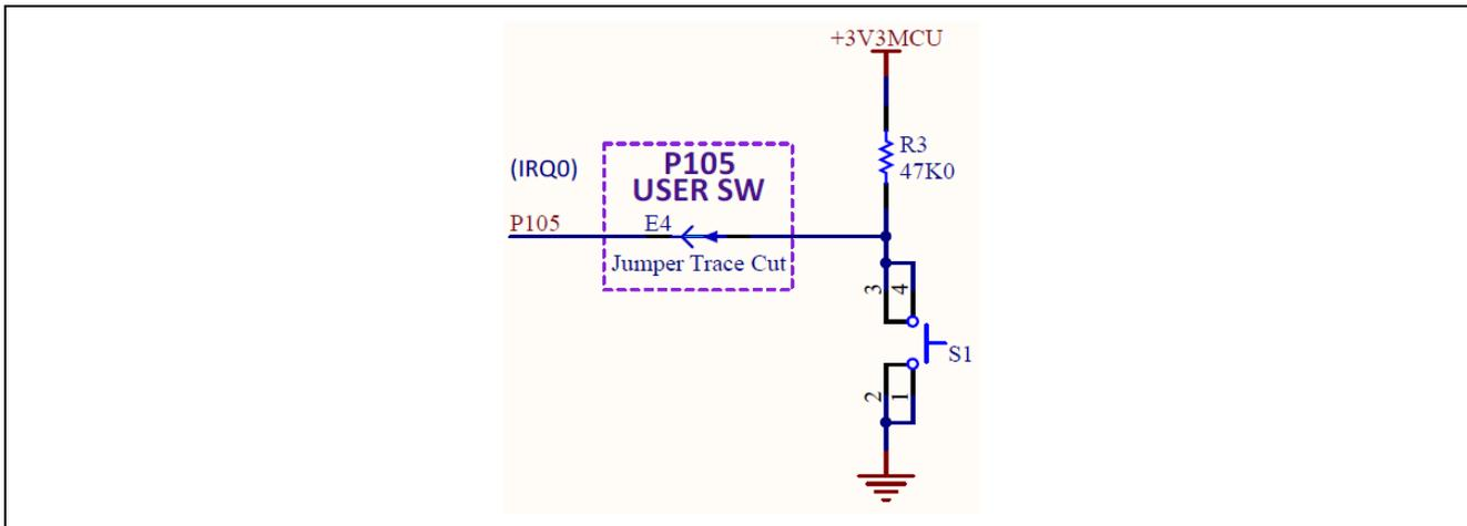
図 16 ユーザスイッチ回路
