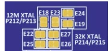
12 MHz クロック水晶発振子用の MCU ピンは、P212 と P213 に接続することができます。12 MHz の水晶発振子を非接続にするには、はんだジャンパ E23 と E24 をオープンし、はんだジャンパ E18 と E19 をクローズします。
