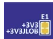
J-Link® MCU 電源はんだジャンパ E1 は、メインの+3.3 V 電源を J-Link® +3.3 V 電源に接続します。E1 は初期設定でクローズされており、J-Link® MCU の電源をメインの+3.3 V 電源に接続します。J-Link®信号が切断されている場合は、E1 をオープンに変更して J-Link® MCU への電源を無くす必要があります。
