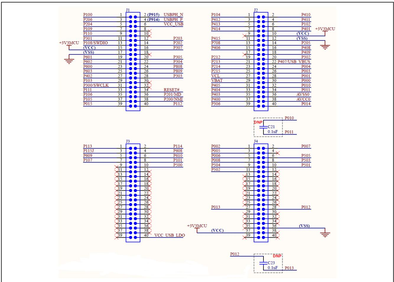
図 24 EK-RA4M1 ピンヘッド回路
