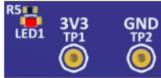
図 8 本評価キットボードのテストポイント TP1、TP2、および LED1
