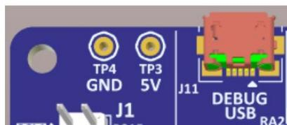
図 7 本評価キットボードの USB デバッグコネクタ (J11)、TP3、および TP4
