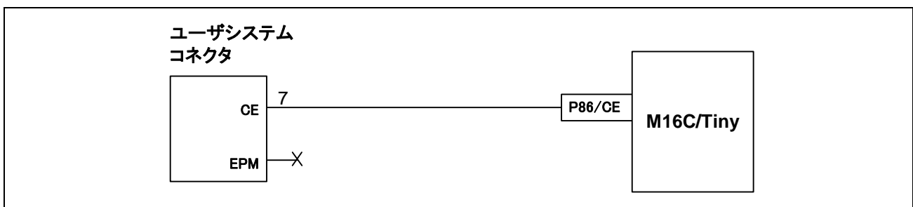
図 5.3 E8 エミュレータと P86 端子の接続
