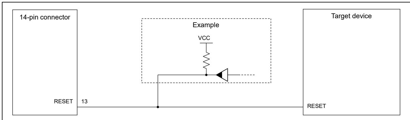
図 2-7 リセット回路接続例
