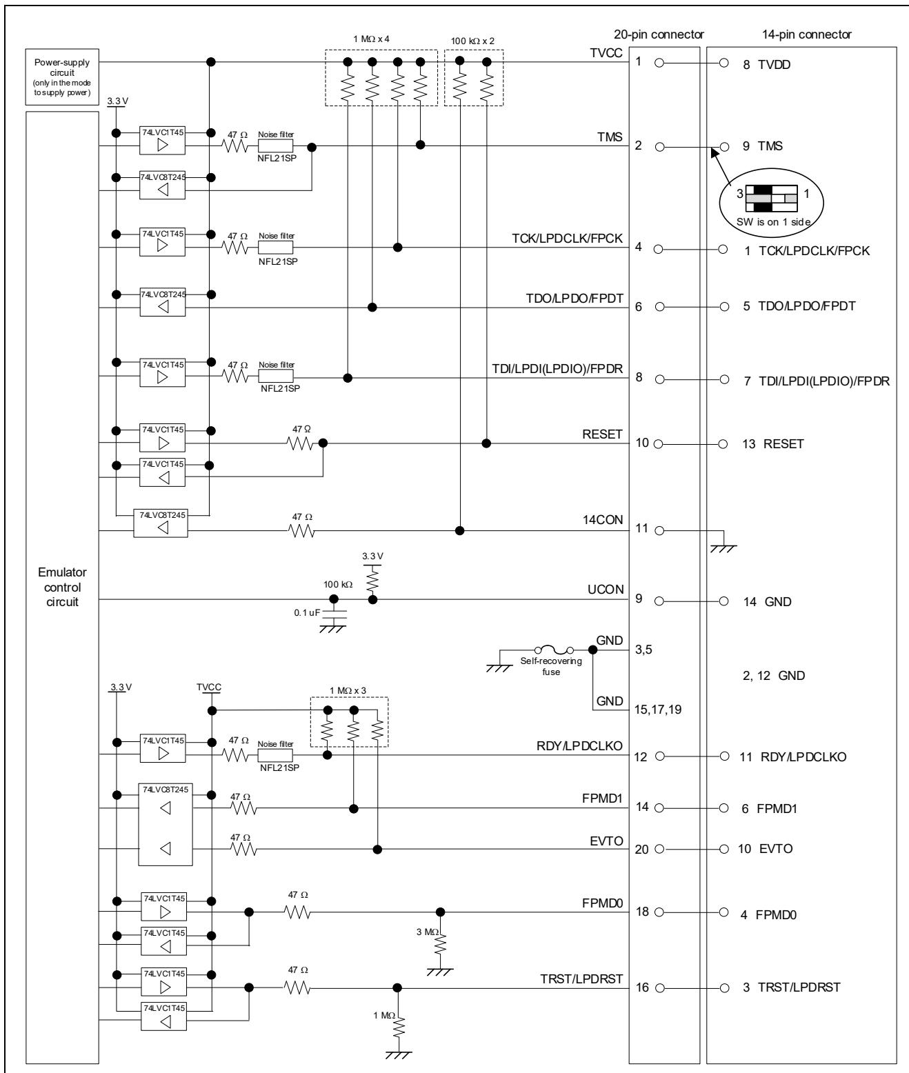
図 5-3 E2 エミュレータ(Rev.C)内インタフェース回路
