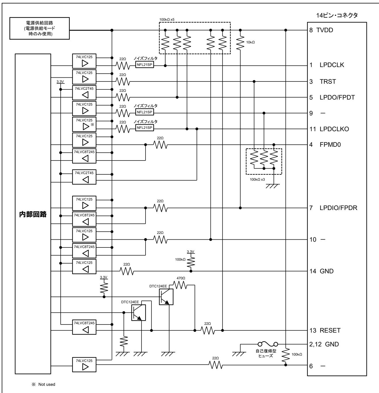
図 5-1 E1/E20 エミュレータ内インターフェース回路(LPD 4pin、2wireUART)
