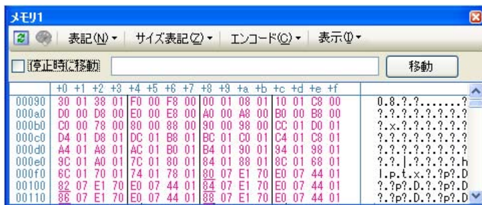
図 2—103 リアルタイム表示更新を行っているメモリ表示の例（メモリパネル）
