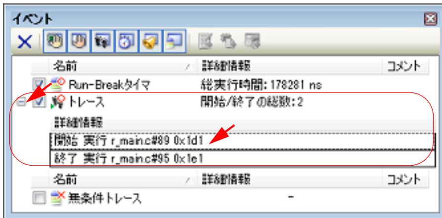
**備考 1.** トレース開始イベント／トレース終了イベントのいずれかが**有効状態**で設定されると、**イベントパネル**上の無条件トレース・イベントのチェックが自動的に外れ、プログラムの実行開始に連動したトレース・データの収集は行いません（設定したトレース開始イベントの条件が成立するまでトレースは動作しません）。
