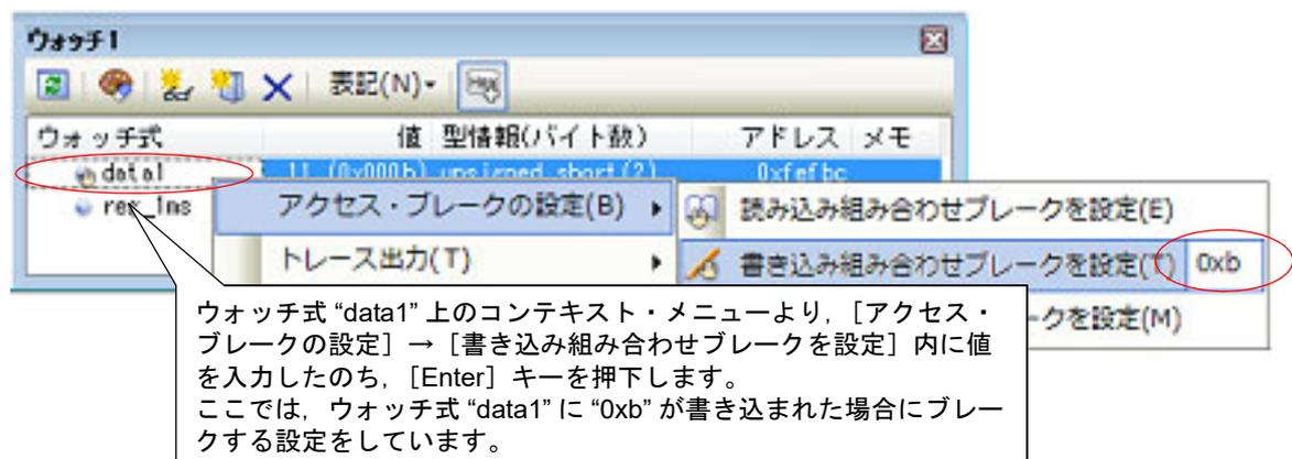
以上の操作を行うことにより、ブレーク・イベント（アクセス系）が設定されると、イベントパネルにおいて、ハードウェア・ブレーク・イベント（アクセス系）、または組み合わせブレーク・イベント【E1】【E20】の詳細情報内のアクセス系イベントとして管理されます（「2.15 イベントの管理」参照）。
