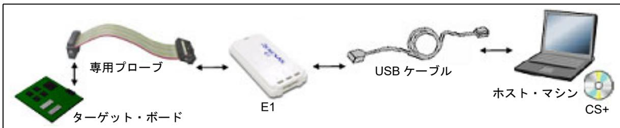
**注意** ターゲット・ボードとの通信方式として、シリアル通信のみサポートしています（JTAG 通信は使用不可）。
