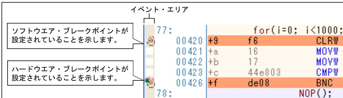
図 2.36 イベント パネルのブレークポイントの設定例
