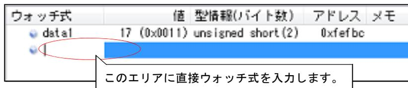
エン트리・ボックス内に、キーボードより直接ウォッチ式を入力したのち、[Enter] キーを押下します。なお、この際のウォッチ式の入力形式については、次の表を参照してください。
