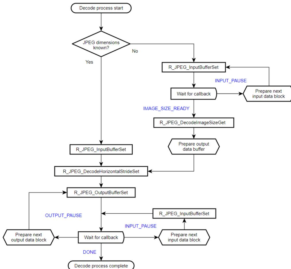
Figure 215: JPEG Decode Operational Flow
