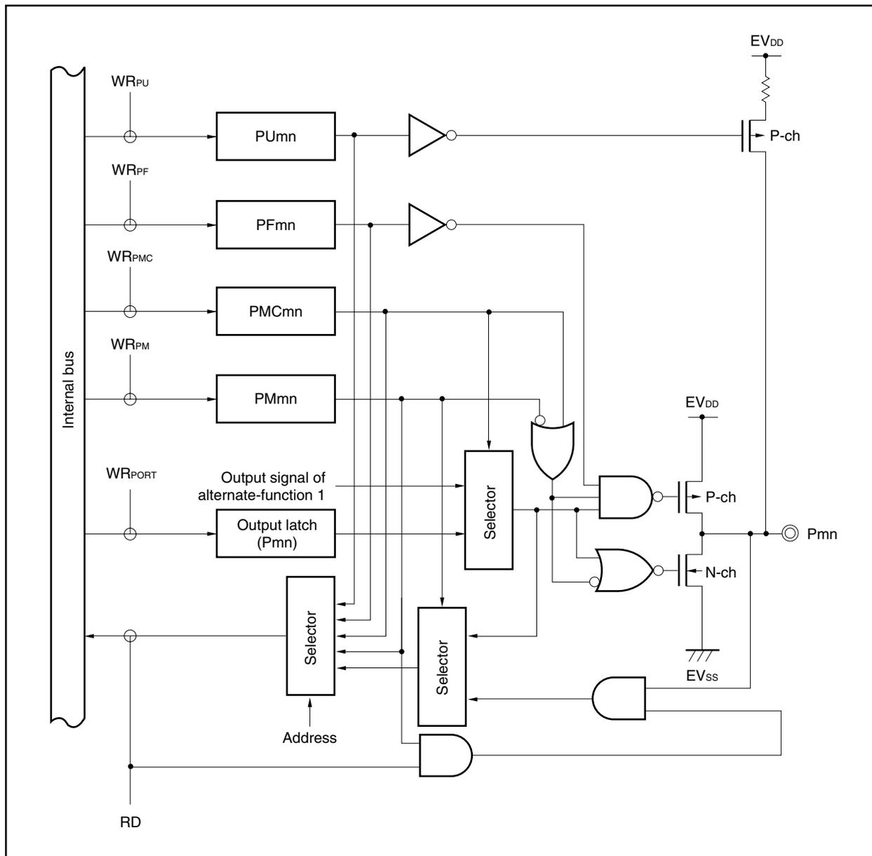
Figure 4-9. Block Diagram of Type D1-SUIL
