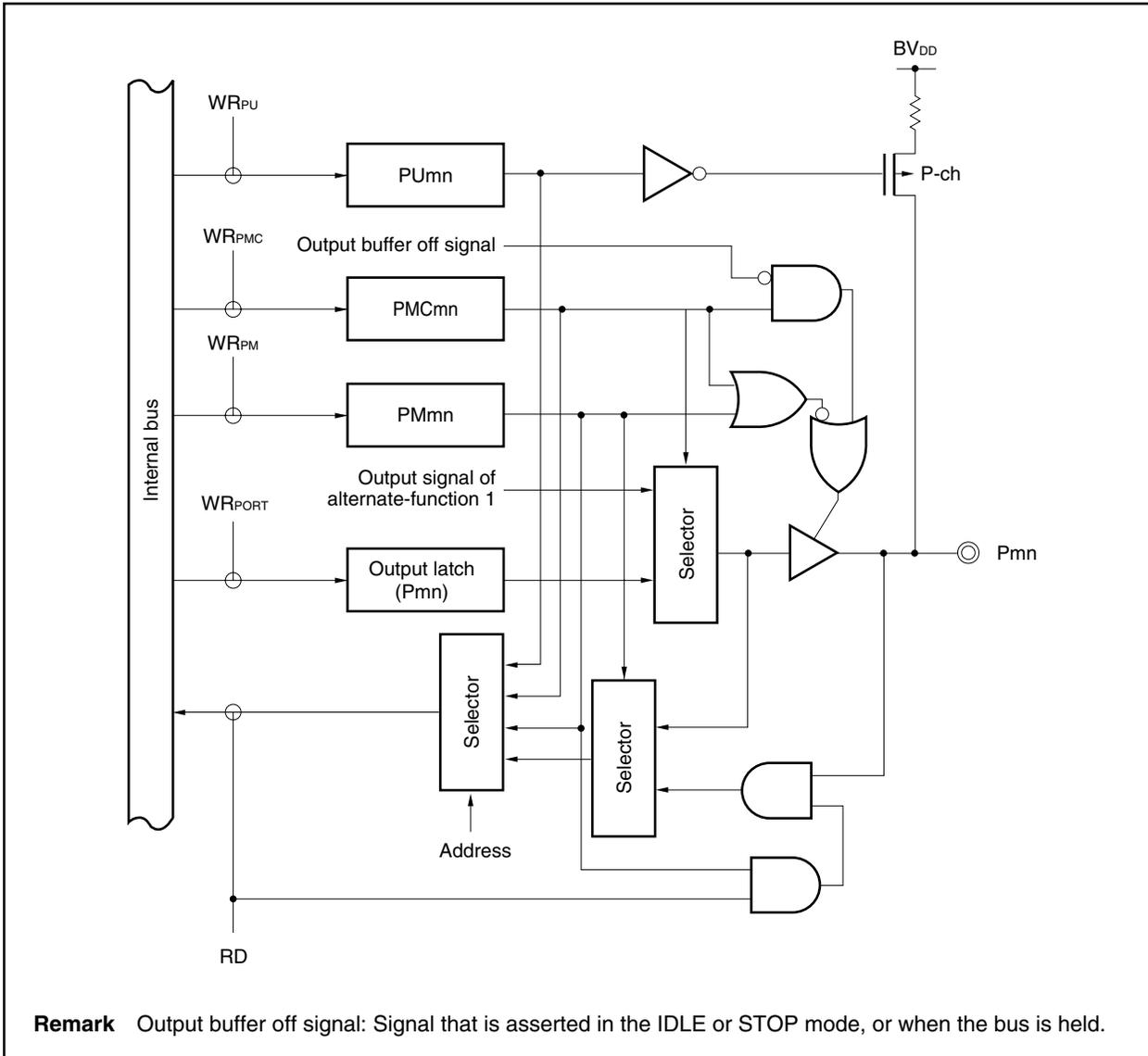
Figure 4-9. Block Diagram of Type D1-SUIL
