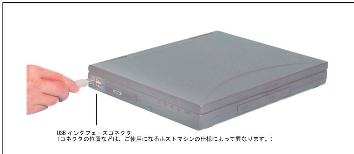
図4.4 USBインタフェースケーブルの接続(ホストマシン側)
