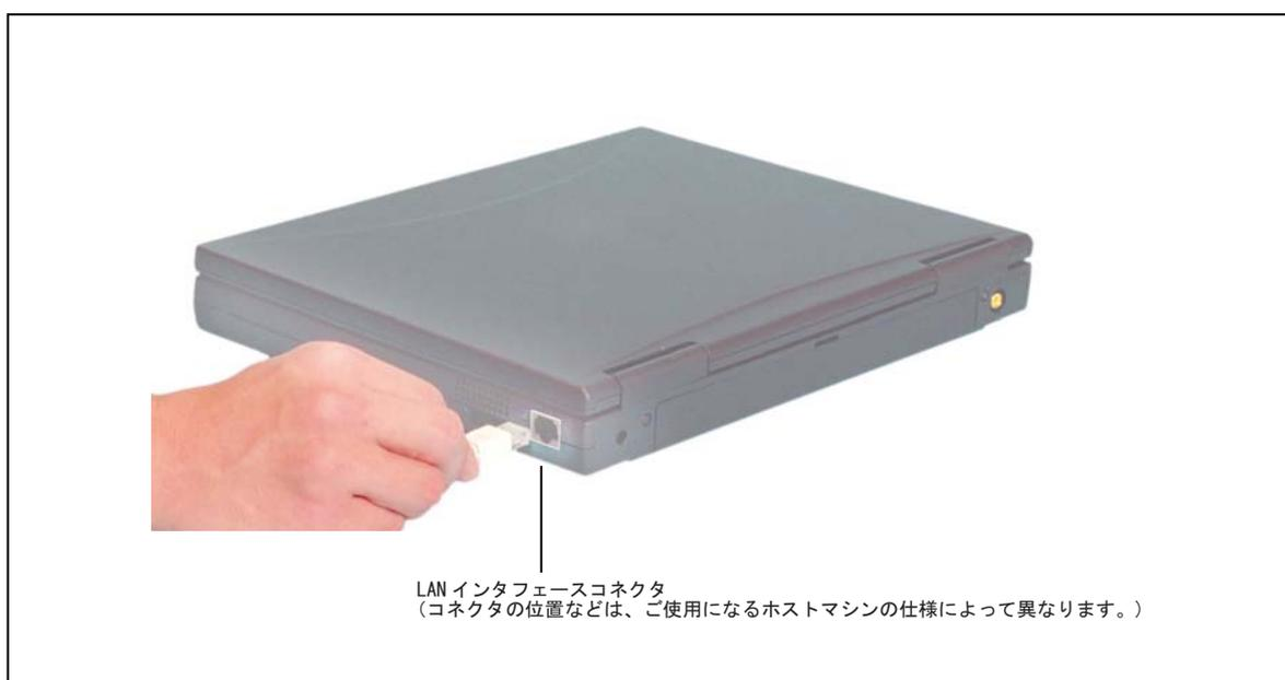
図4.7 LANインタフェースケーブルの接続(ホストマシン側)
