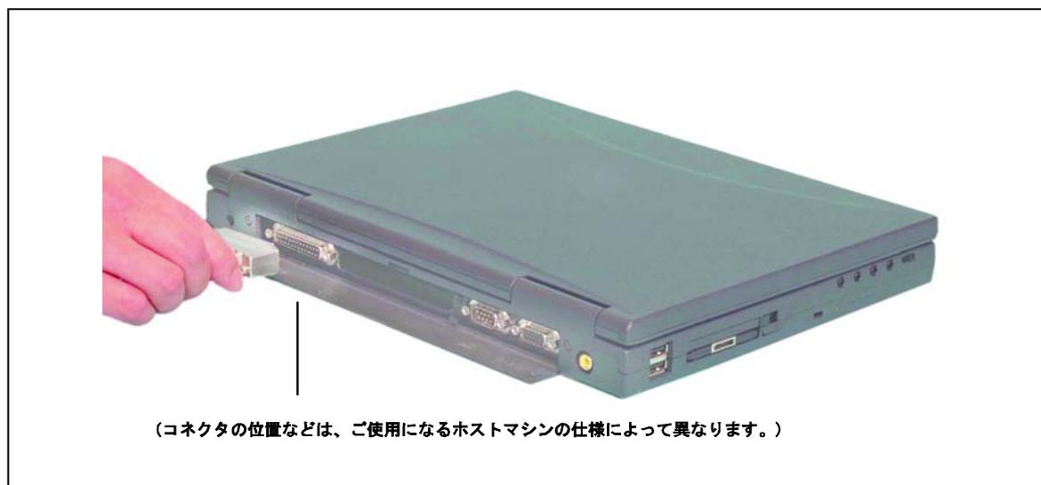
図4.2 LPTパラレルインタフェースケーブルの接続(ホストマシン側)
