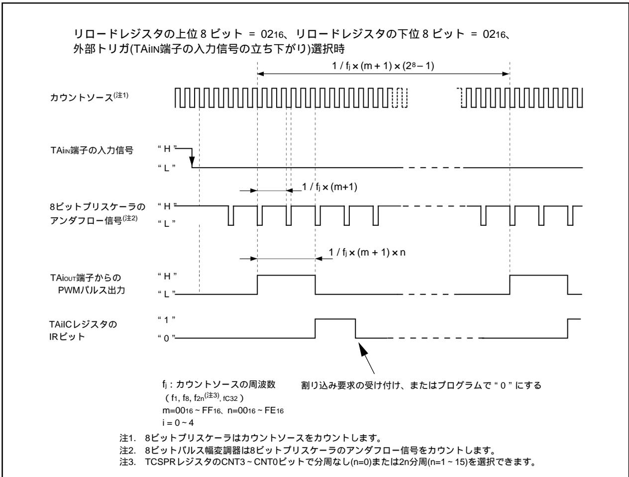
図15.15 8ビットパルス幅変調器の動作例
