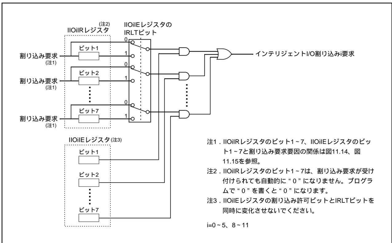
図11.13 インテリジェントI/O割り込みとCAN割り込みのブロック図
