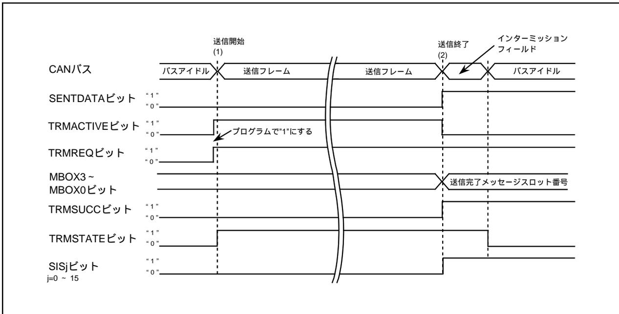
図23.36 CANデータフレーム送信時の動作例
