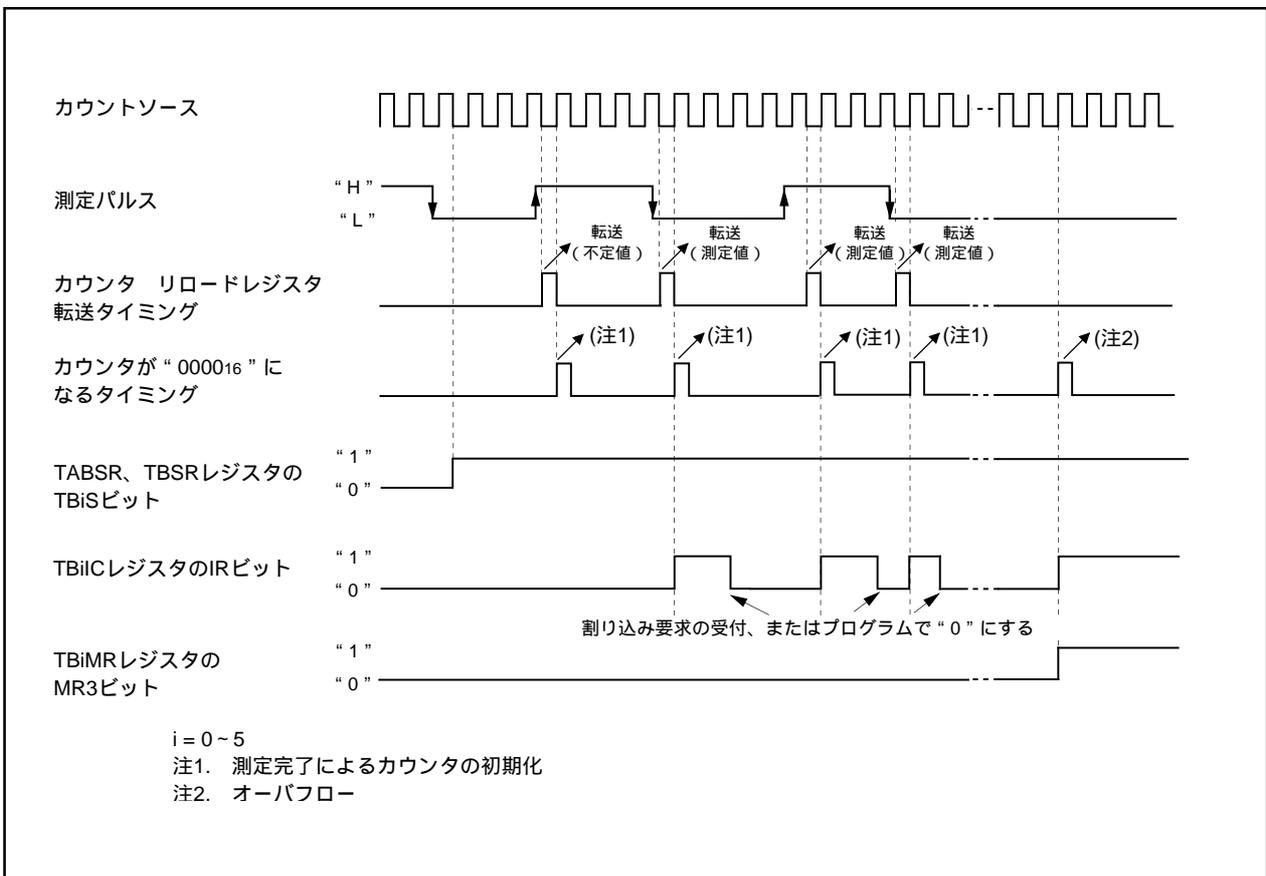
図15.24 パルス幅測定時の動作図
