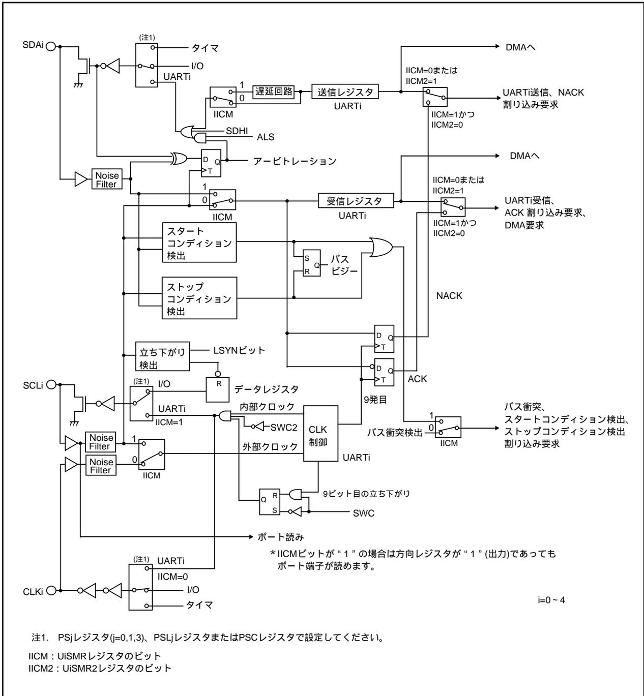
図17.19 I<sup>2</sup>Cモードのブロック図
