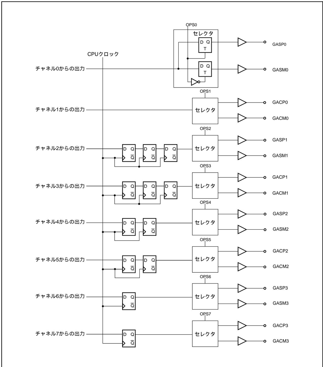
図22.32 ステッピングモータ制御機能のブロック図
