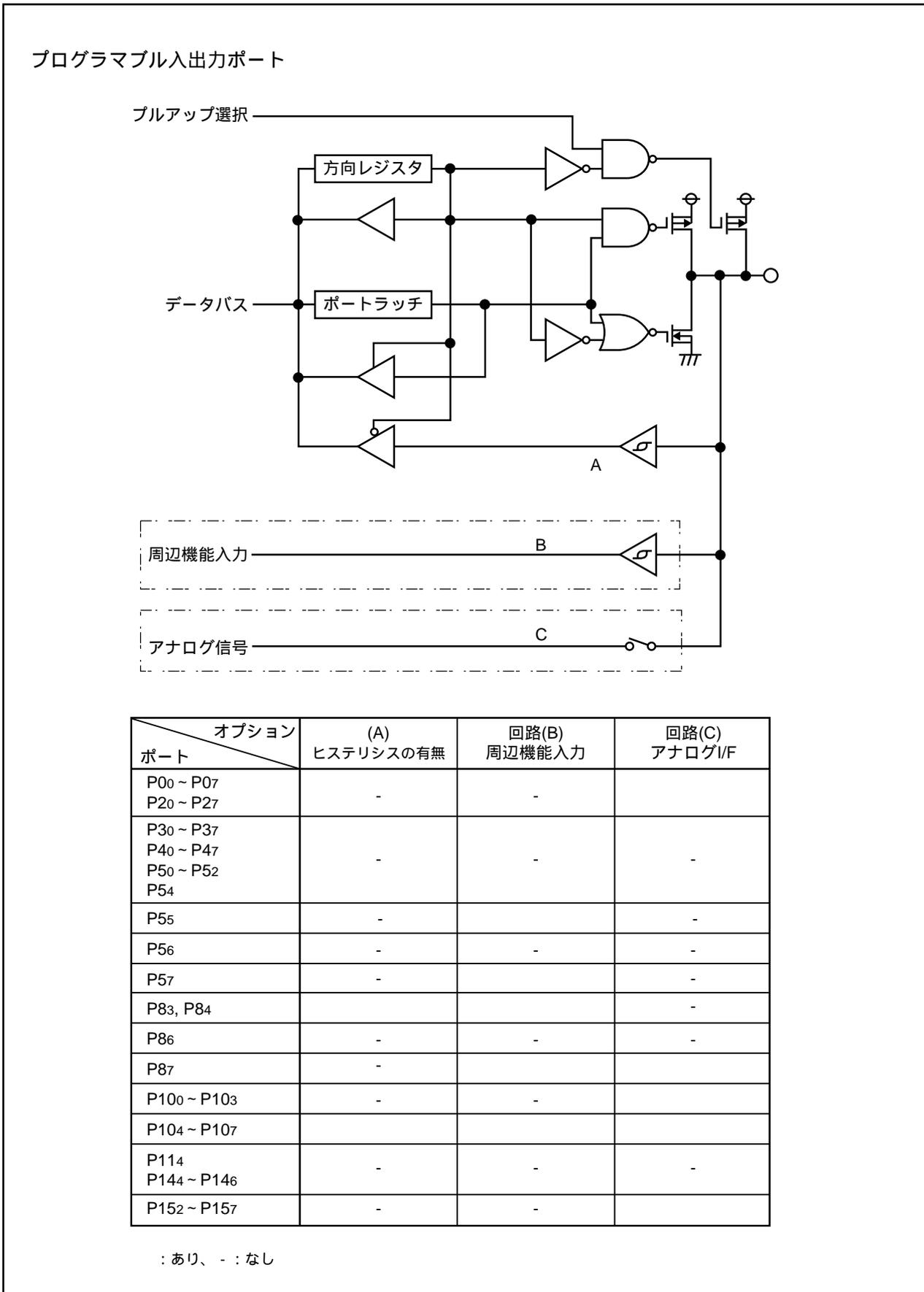
図24.1 プログラマブル入出力ポートの構成(1)
