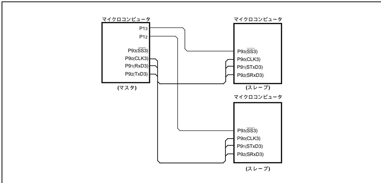
図17.23  $\overline{\text{SS}}$ 端子を用いたシリアルバスの通信制御例
