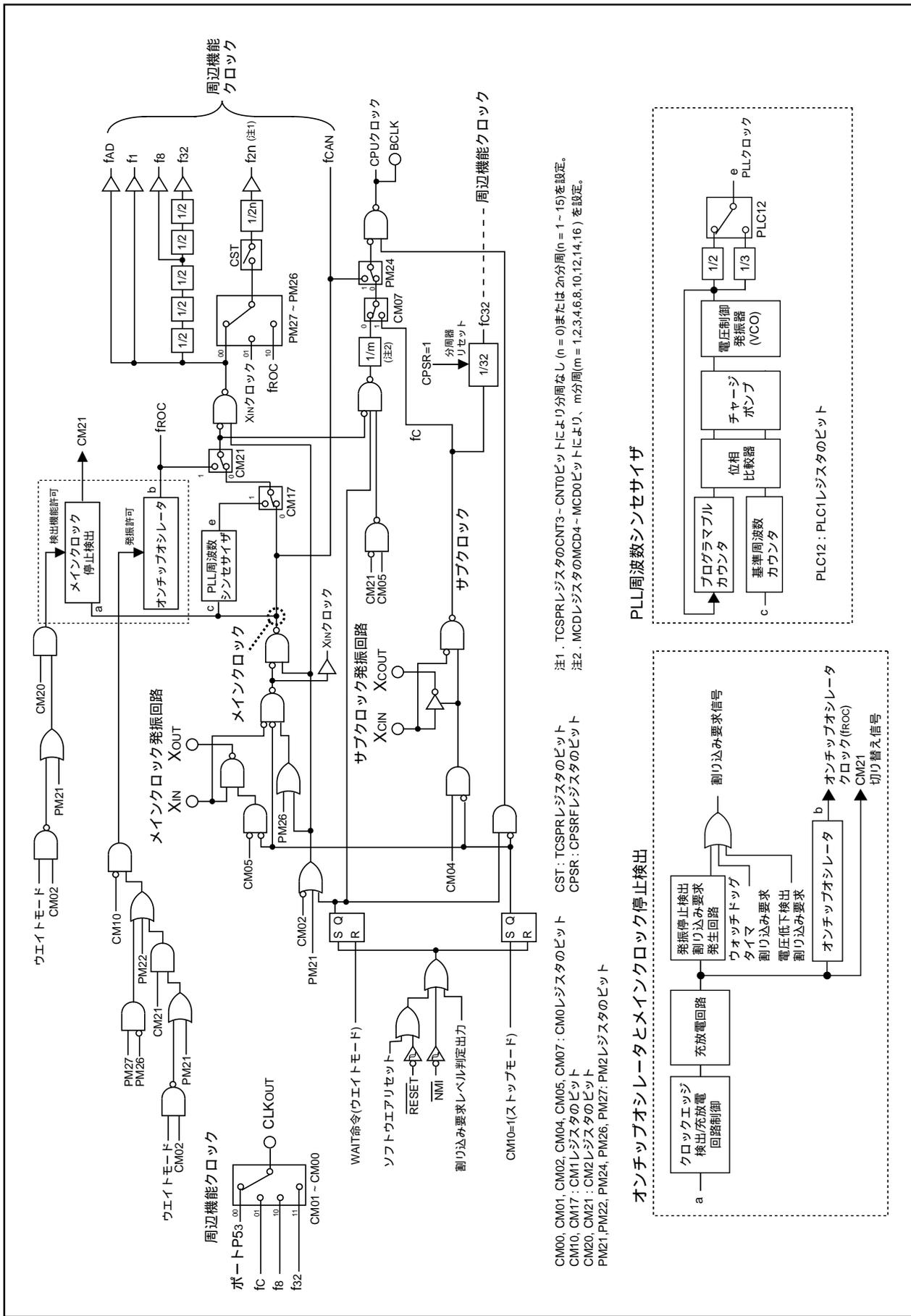
図9.1 クロック発生回路のブロック図
