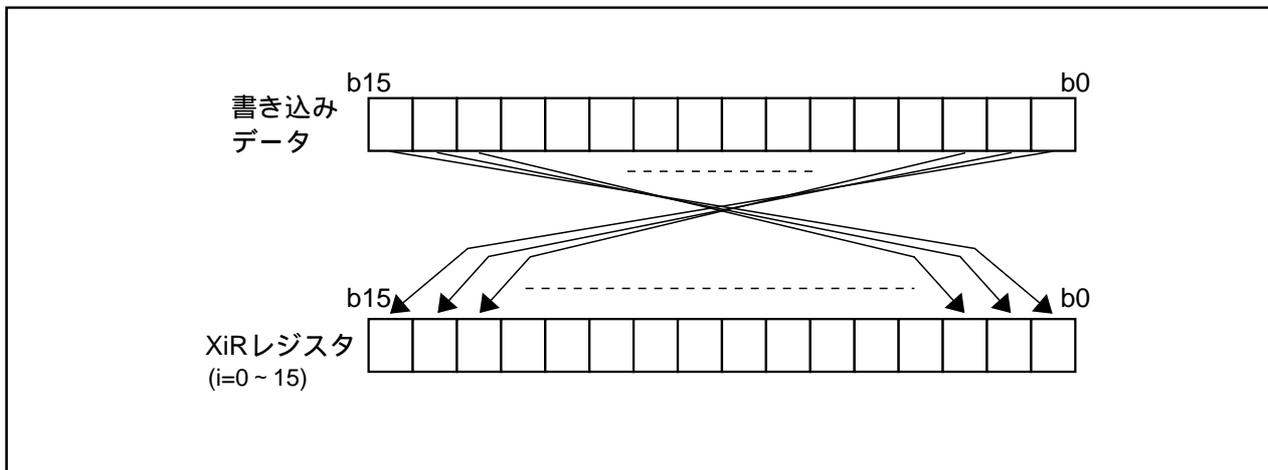
図21.5 XYC1ビットが“1”の場合の変換
