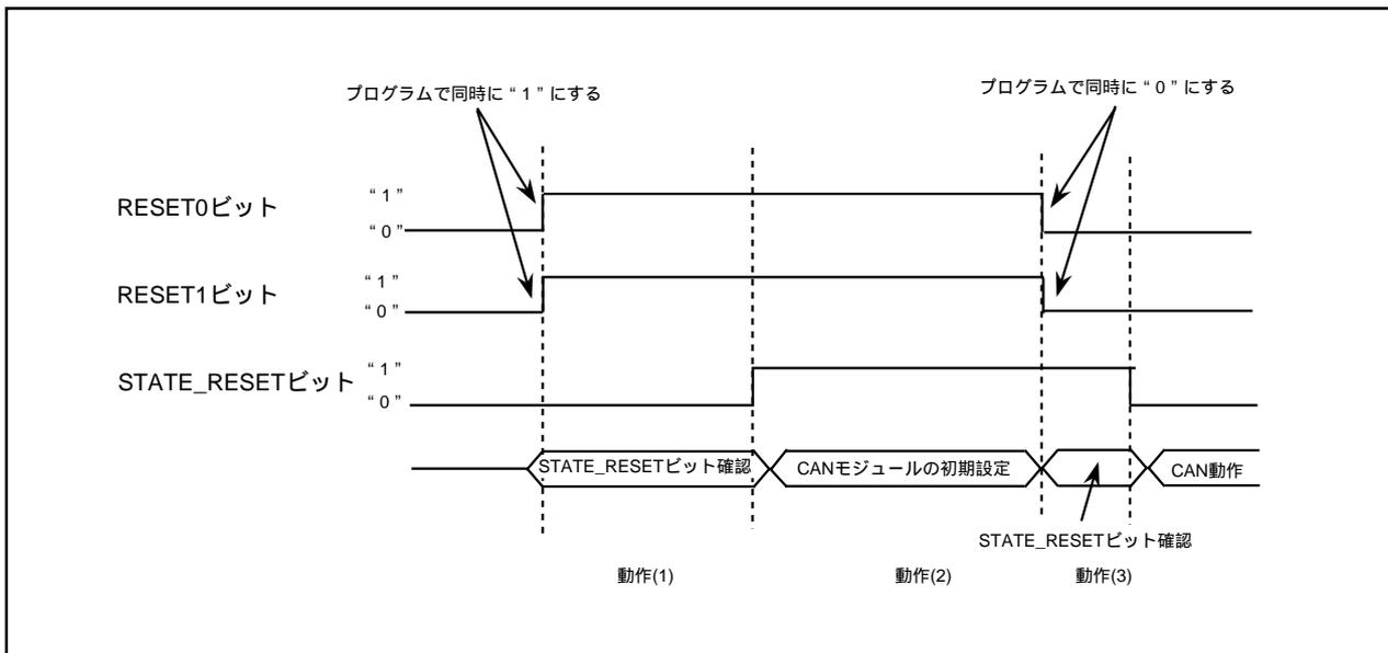
図23.35 CANモジュール初期化時の動作例
