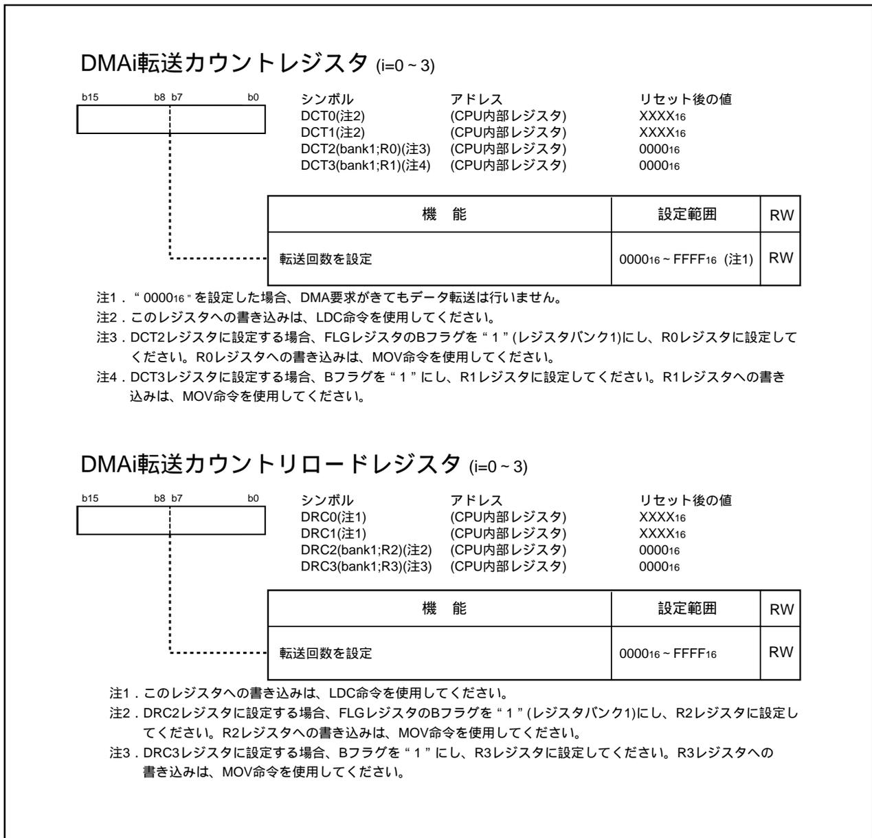
図13.4 DCT0~DCT3レジスタ、DRC0~DRC3レジスタ
