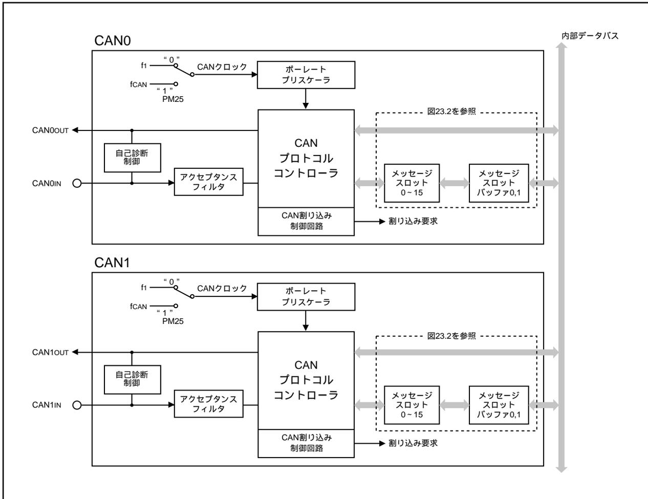
図23.1 CANモジュールブロック図
