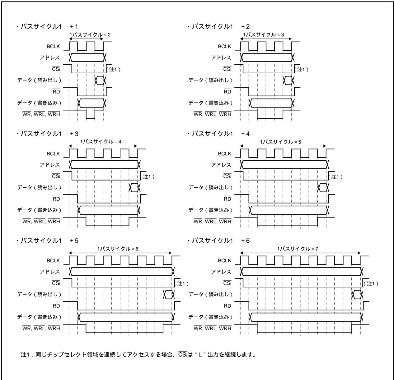
図8.4 セパレートバス選択時のバスサイクル(1)
