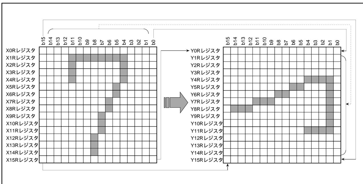
図21.3 X/Y変換例
