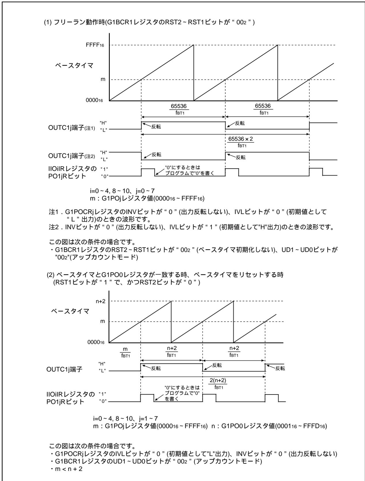
図22.17 反転波形出力モード時の動作例
