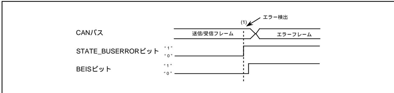
図23.38 CANバスエラー発生時の動作例
