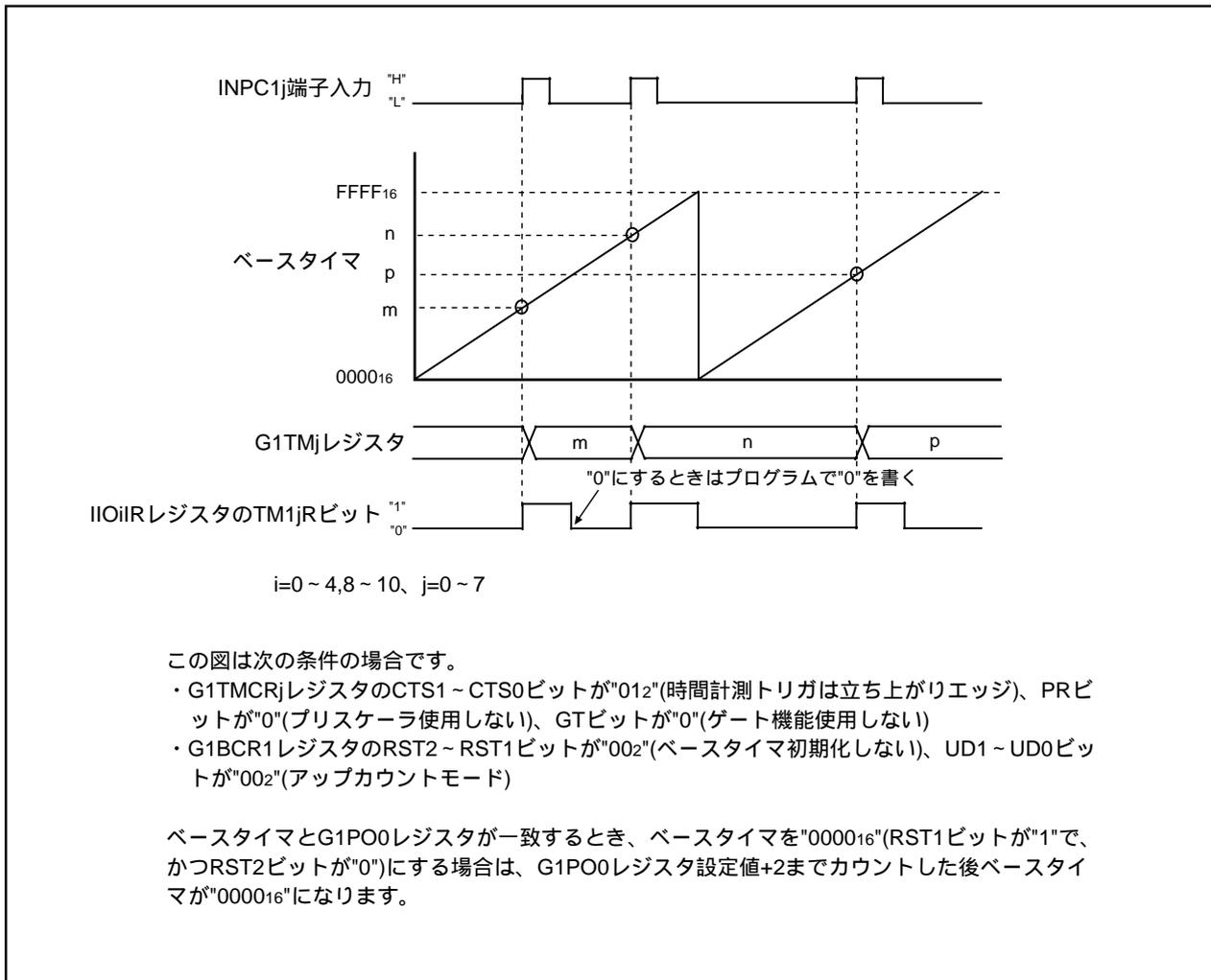
図22.13 時間計測機能の動作例 (1)
