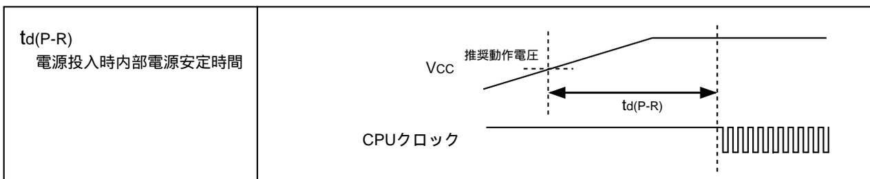
図26.7 電源回路のタイミング図
