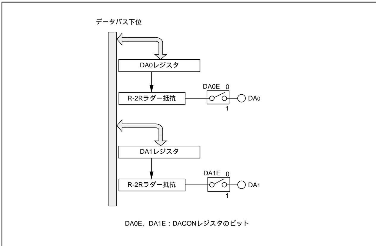
図19.1 D/Aコンバータのブロック図
