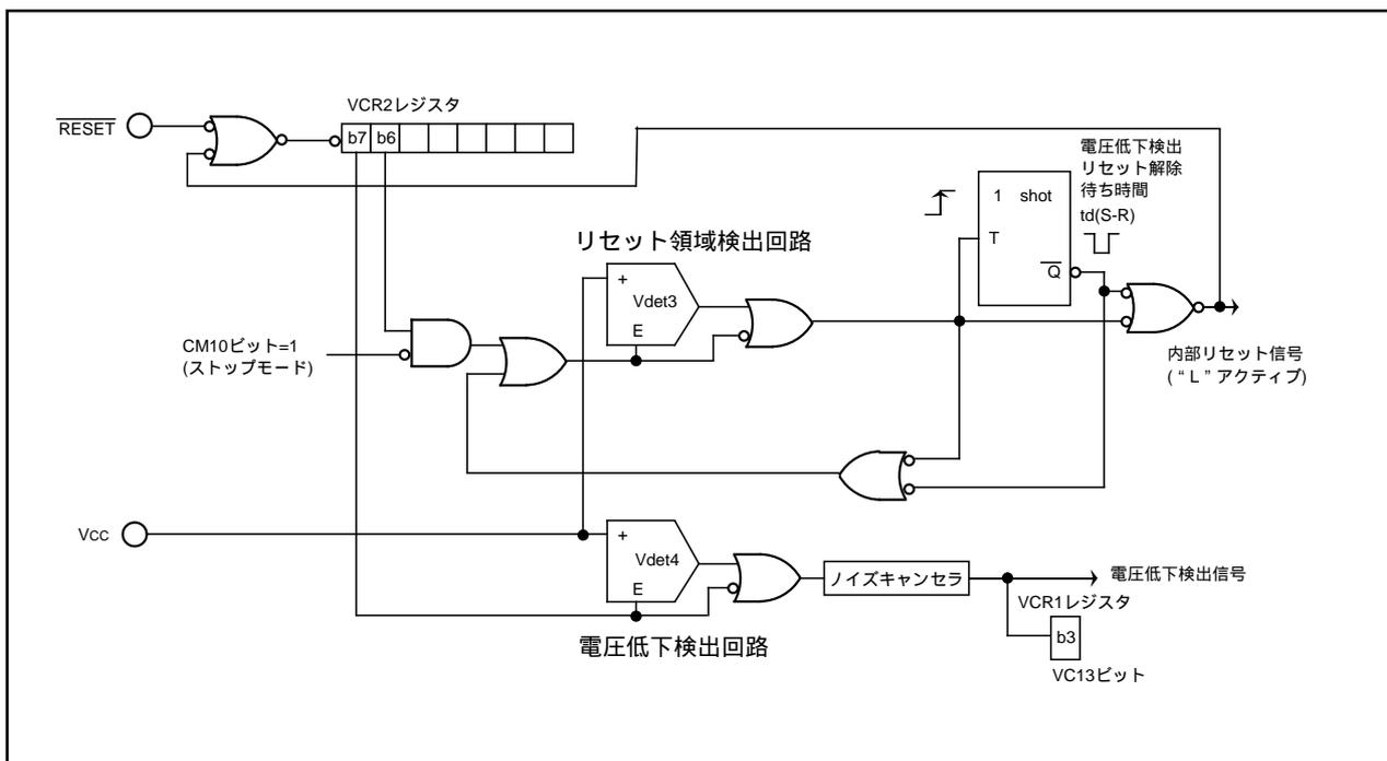
図6.1 電圧検出回路ブロック図
