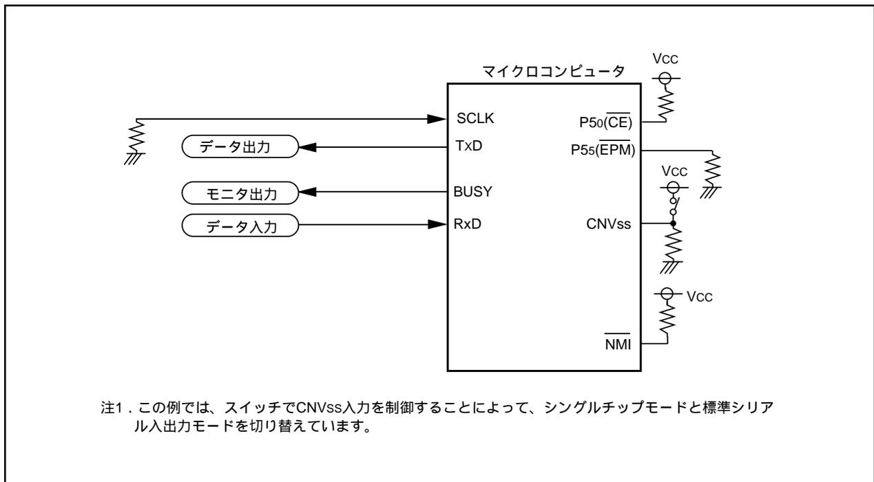
図25.16 標準シリアル入出力モード2の端子処理例
