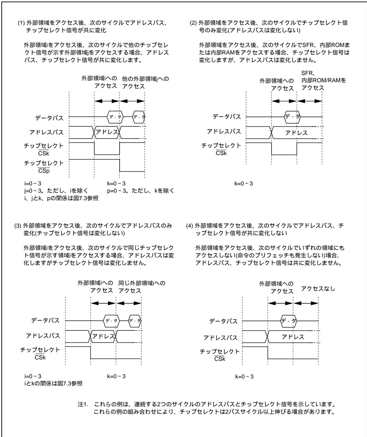
図8.2 アドレスバスとチップセレクト信号の出力例(セパレートバス)
