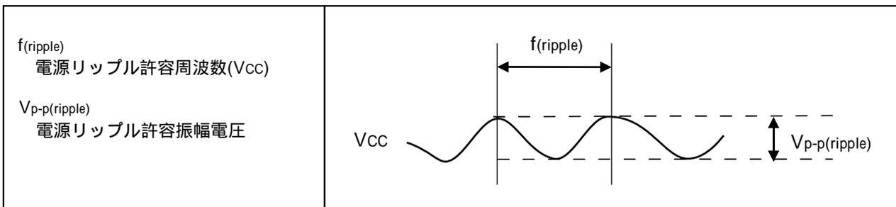
図27.2 電源変動のタイミング図
