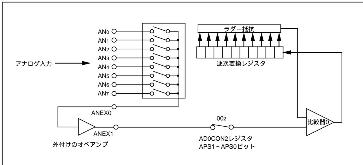
図18.7 外部オペアンプ接続モードの接続例
