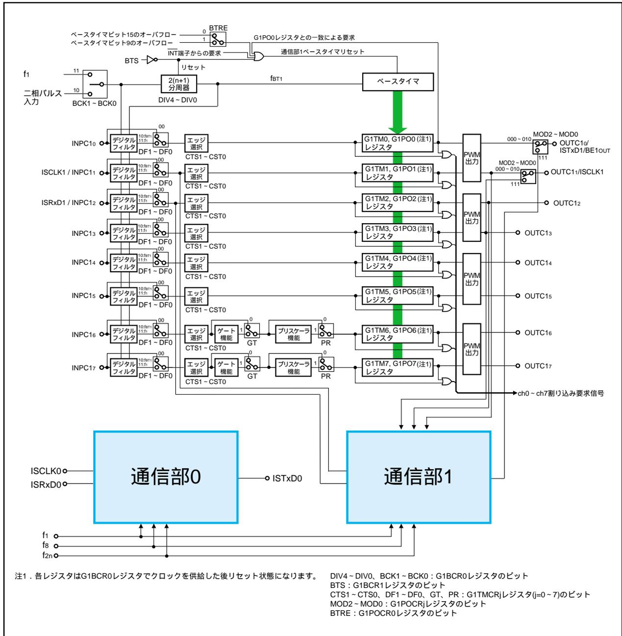
図22.1 インテリジェントI/Oブロック図
