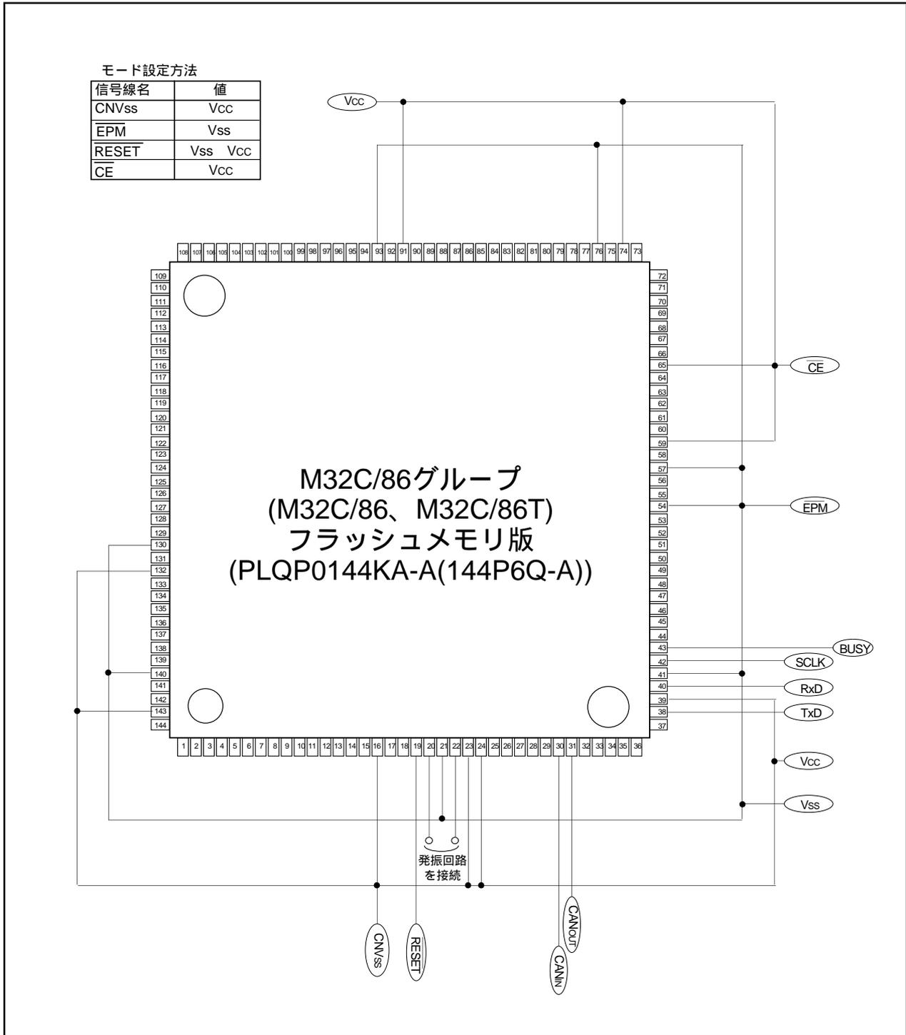
図25.14 標準シリアル入出力モード時の端子結線図
