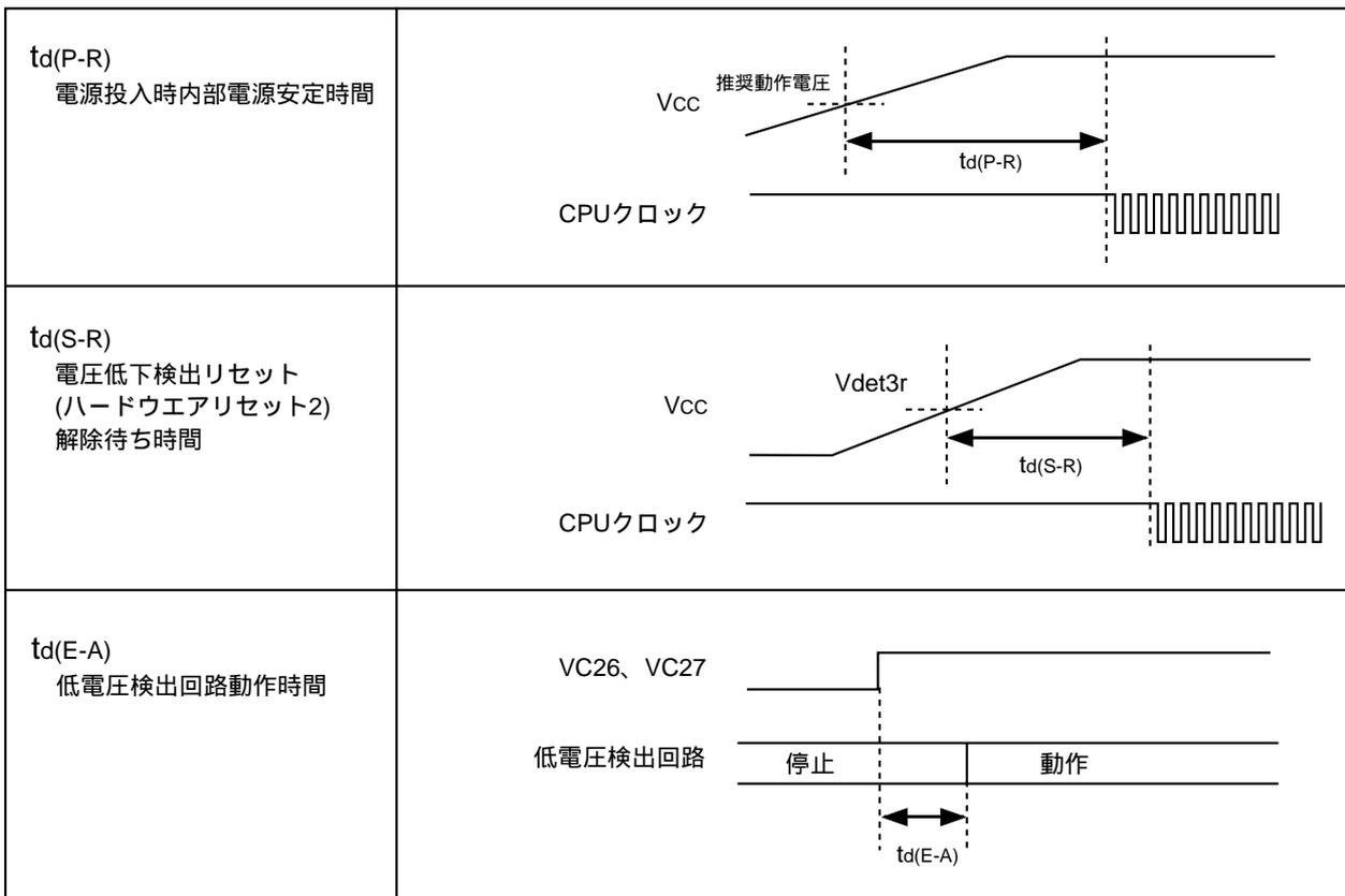
図26.1 電源回路のタイミング図
