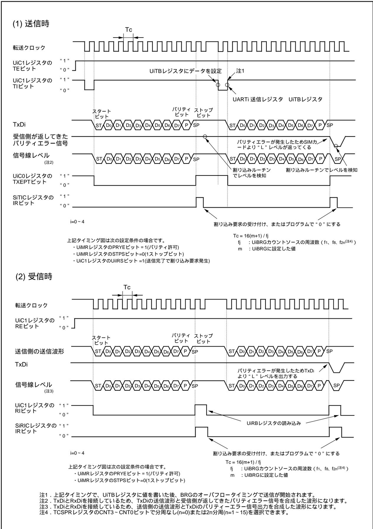
図17.29 SIMインタフェース 動作例
