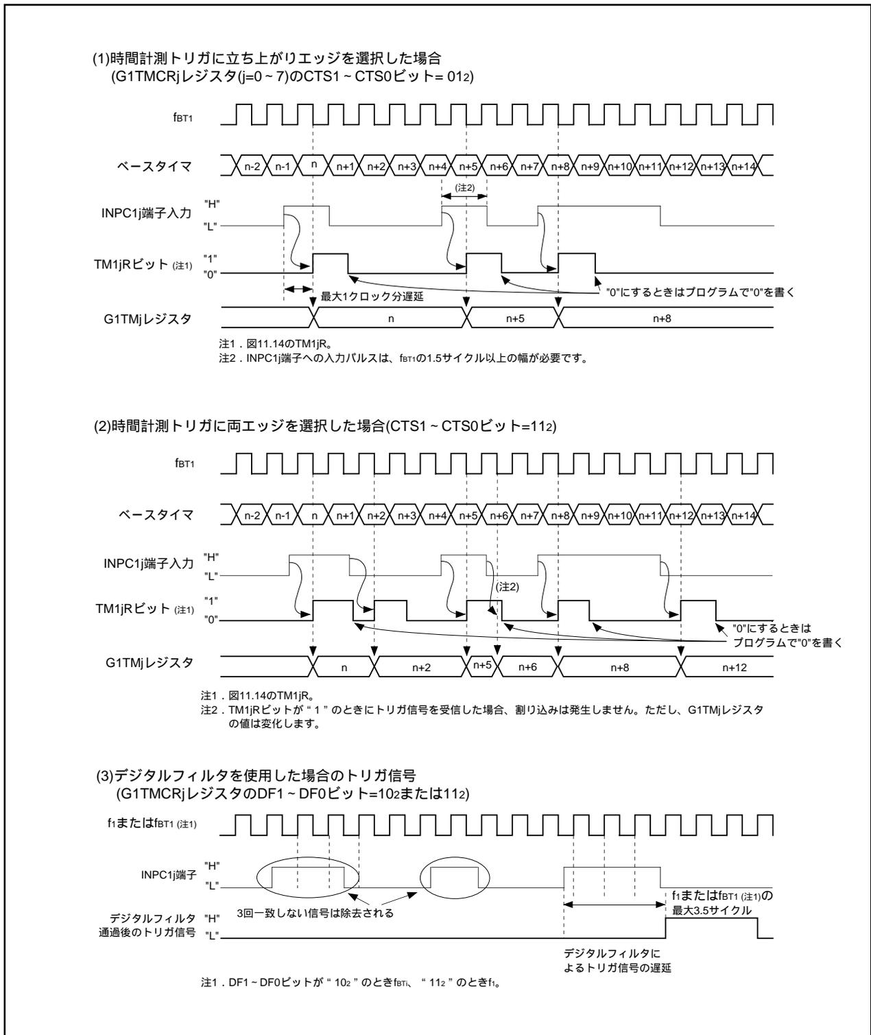
図22.14 時間計測機能の動作例 (2)
