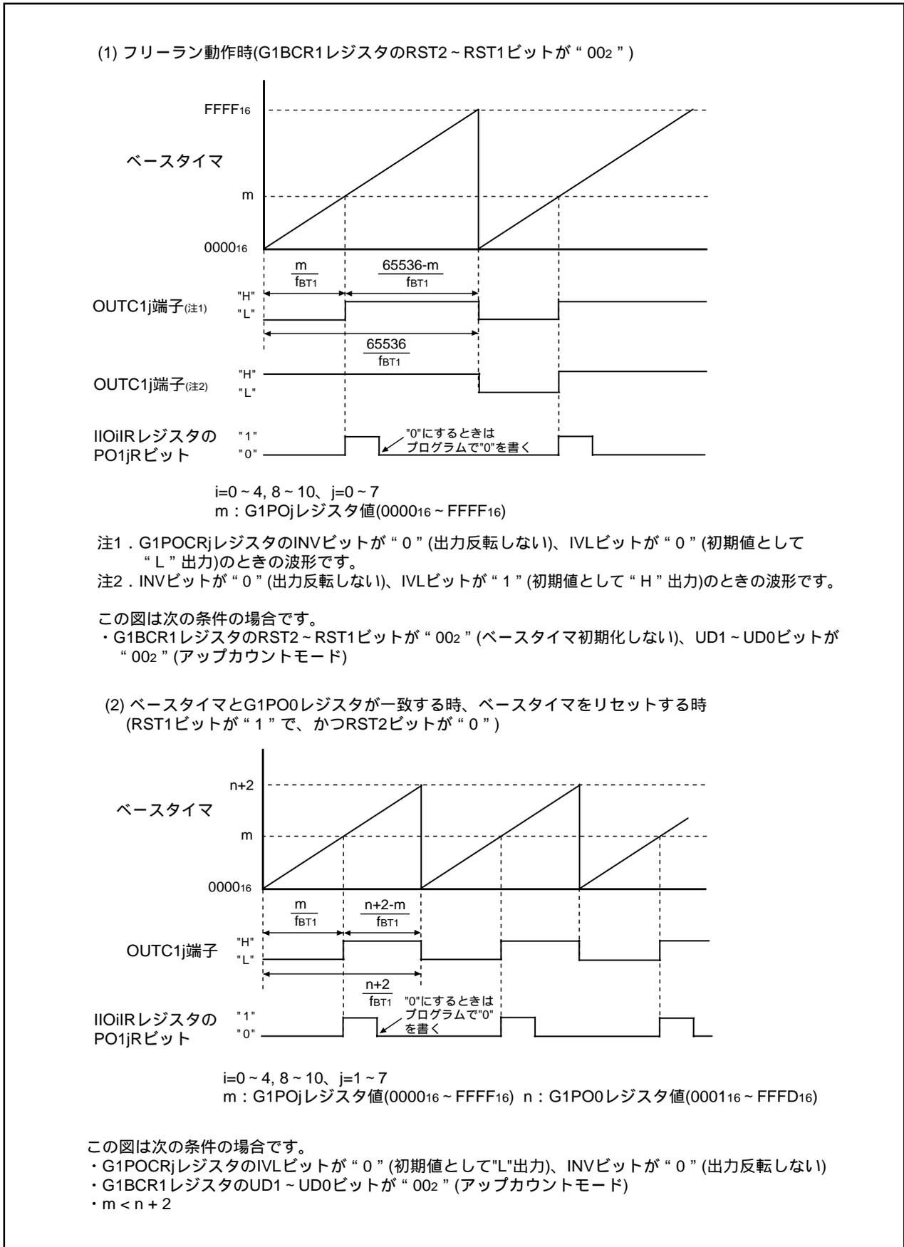
図22.16 単相波形出力モードの動作例
