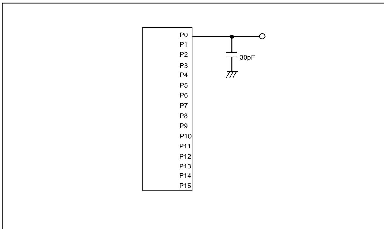
図26.8 ポートP0～P15の測定回路
