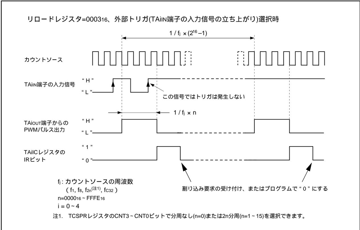
図15.14 16ビットパルス幅変調器の動作例
