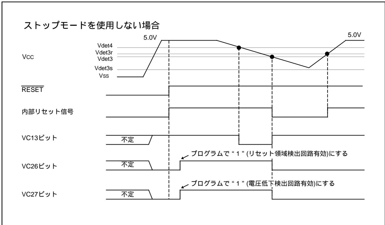
図5.3 電圧低下検出リセットの動作例
