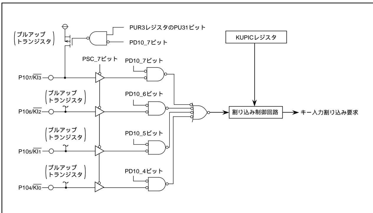
図11.11 キー入力割り込みのブロック図
