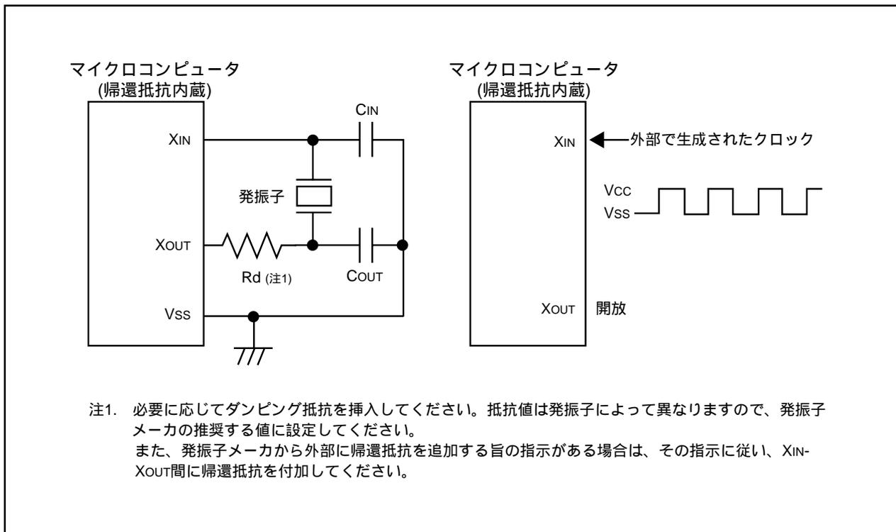
図9.8 メインクロックの接続回路例
