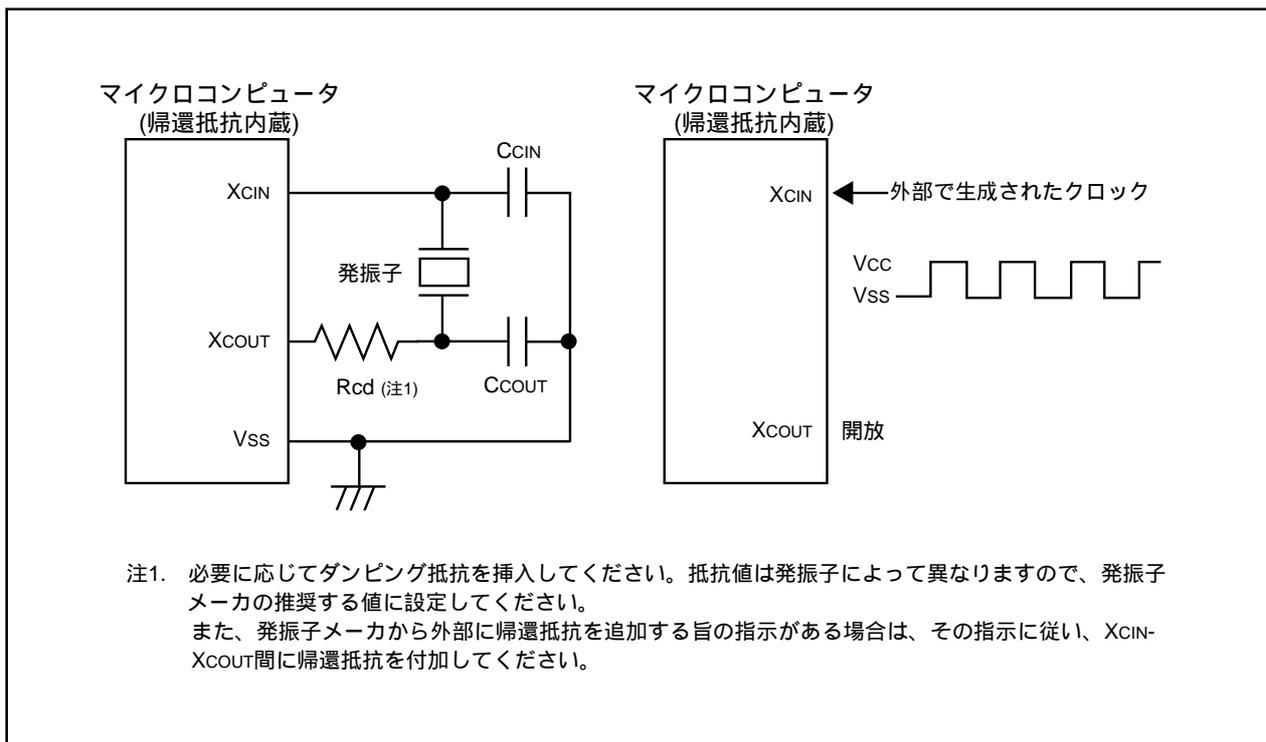
図9.9 サブクロックの接続回路例
