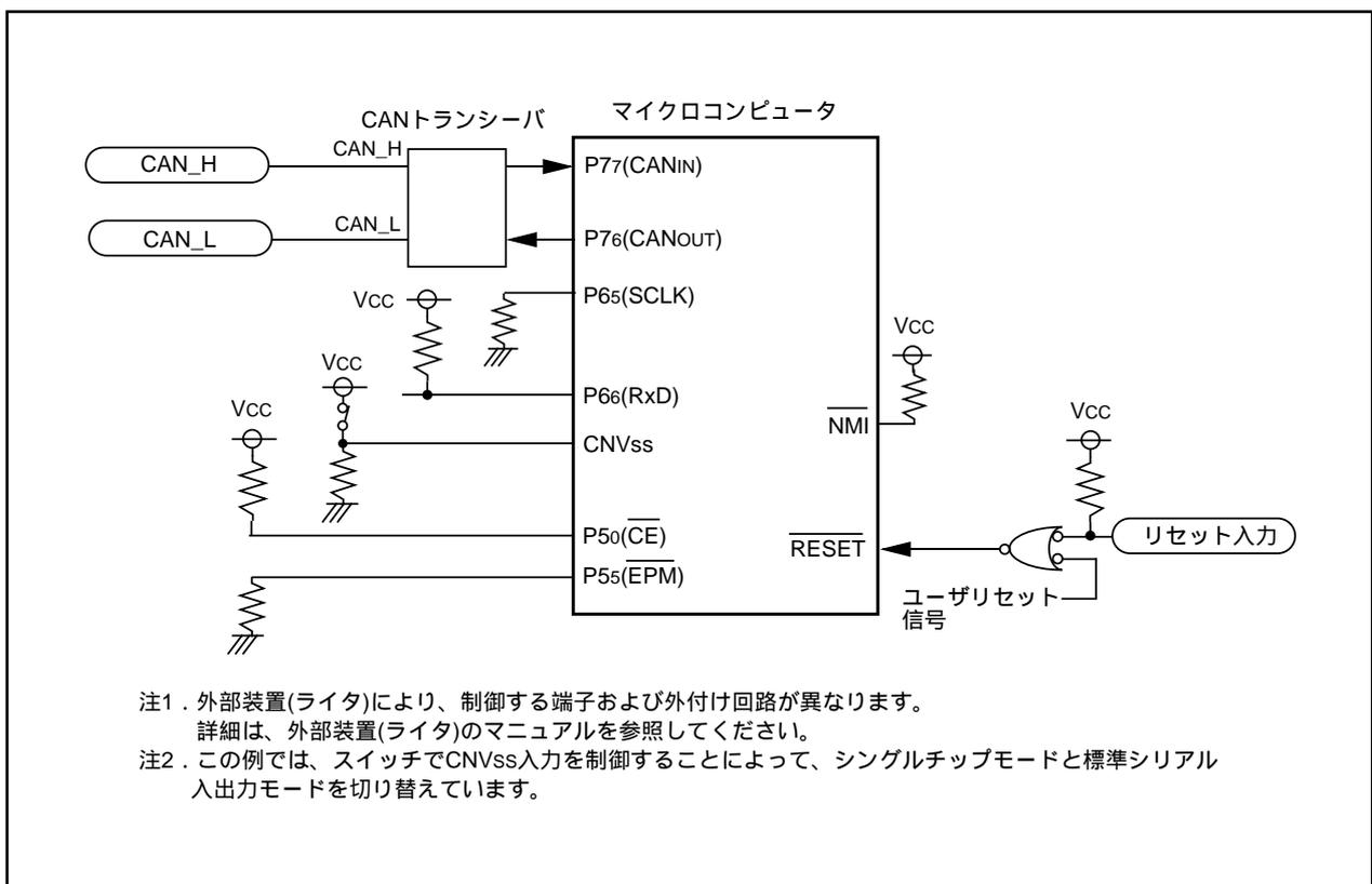
図25.17 標準シリアル入出力モード3の端子処理例
