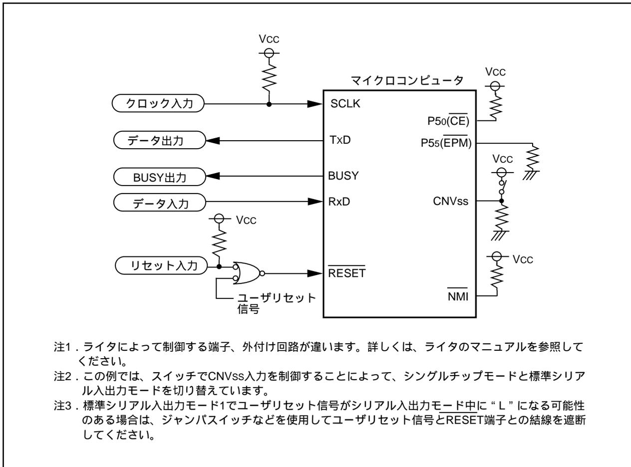
図25.15 標準シリアル入出力モード1の端子処理例
