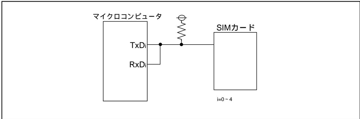
図17.30 SIMインタフェース接続例
