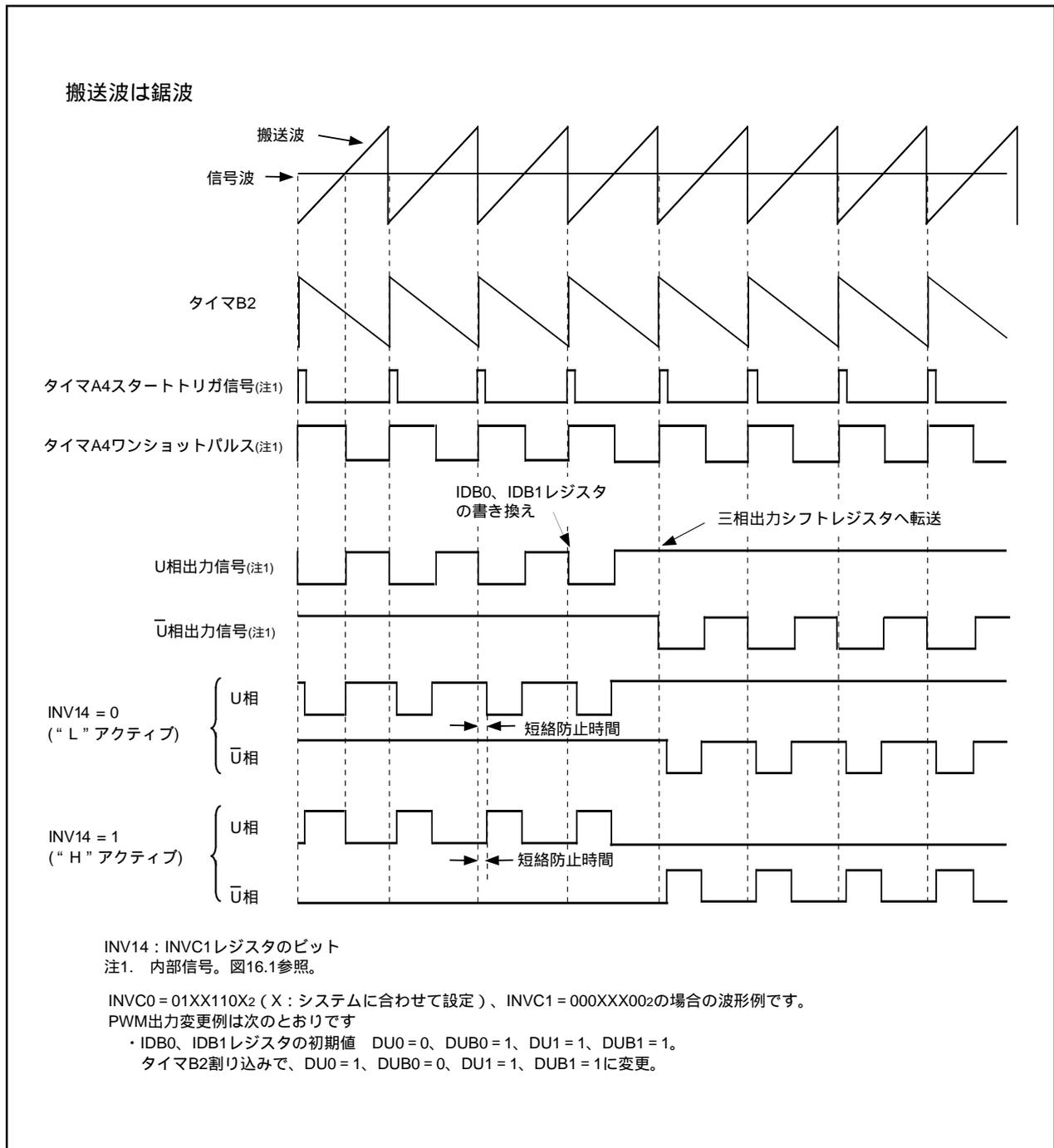
図16.9 鋸波変調動作例
