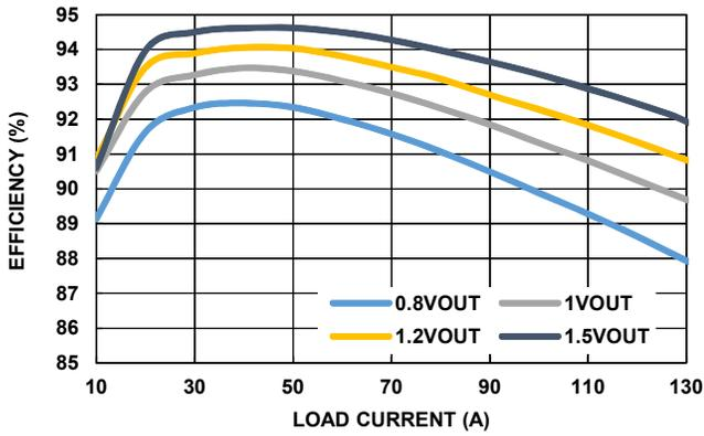
FIGURE 10. 3-PHASE EFFICIENCY
